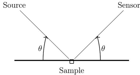
FIGURE 2.4 – Schéma de la diffraction par rayons X
