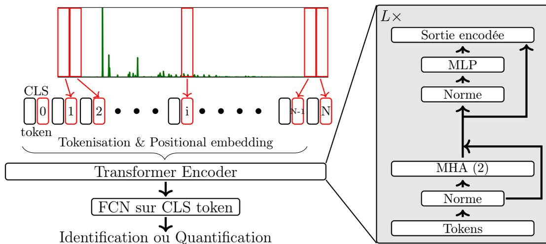
FIGURE 7.3 – Schéma représentant le modèle d'un Transformers.
