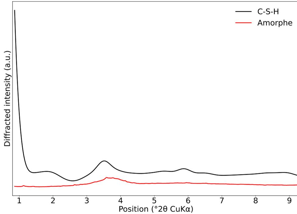
FIGURE 6.5 – Comparaison d’un diffractogramme Amorphe obtenu de manière expérimentale avec un C-S-H simulé avec un nombre de répétitions de mailles tel que  $N_1 = N_2 = 2$  et  $N_3 = 1$ .
