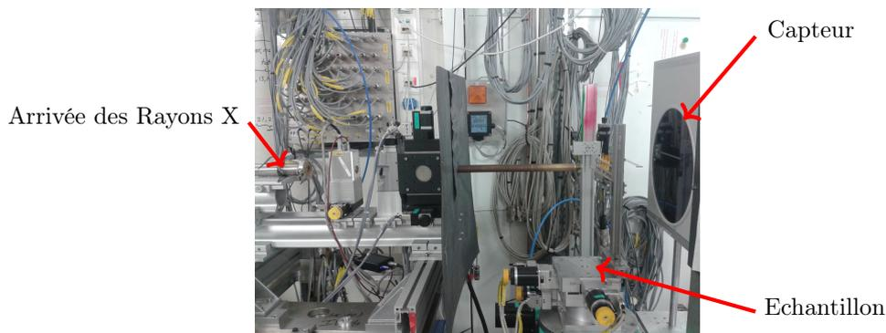
FIGURE 2.7 – Photo de l'appareil de mesure avec le synchrotron (Par S.Grangéon à l'ESRF, Grenoble).
