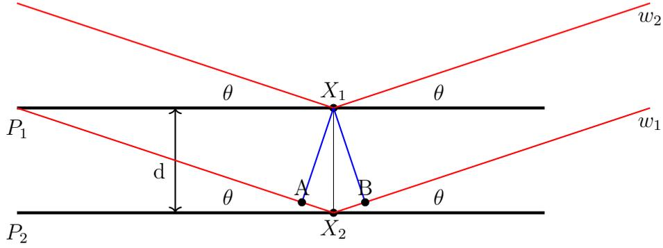
FIGURE 2.11 – Illustration simplifiée de la loi de Bragg entre deux plans  $P_1$  et  $P_2$ , séparés d'une distance  $d$  et soumis à deux ondes de rayons X  $w_1$  et  $w_2$  qui diffractent selon un angle  $\theta$ .
