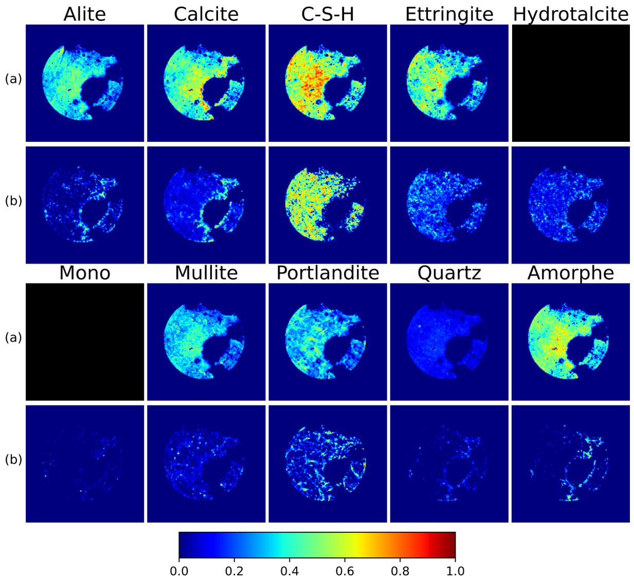
FIGURE 6.8 – Cartes d’abondances pour les dix phases minérales : (a) décrit les résultats de la méthode alternative présentée dans les travaux de CLARET *et al.* (2018) et (b) les résultats de l’approche avec les réseaux de neurones. Les cartes d’abondances pour l’Hydrotalcite et le Monosulfoaluminat avec la méthode de CLARET *et al.* (2018) ne sont pas présentées car ces phases sont simplement à l’état de trace.
