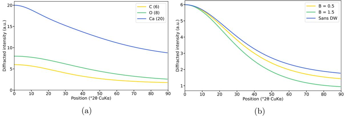
FIGURE 2.9 – (a) Exemples de facteurs de diffusion atomique calculés à partir de l'équation (2.2), pour trois atomes différents : le carbone, l'oxygène et le calcium dont les numéros atomiques sont 6, 8 et 20 respectivement. Ces numéros correspondent au nombre d'électrons qui gravitent dans le nuage autour de leur noyau. La figure (b) est une illustration de l'effet d'agitation thermique (Debye-Waller) avec des valeurs de  $B$  variables.
