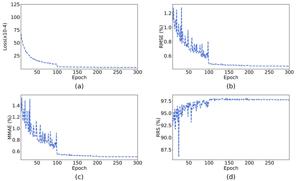
FIGURE 5.8 – Analyse de diffractogrammes simulés : (a) Evolution des valeurs de la *loss* en fonction de la base d’entraînement, avec (b), (c) et (d) qui décrivent les valeurs des mesures (RMSE, MMAE et RRS respectivement) sur l’ensemble de validation au cours des époques d’entraînement.
