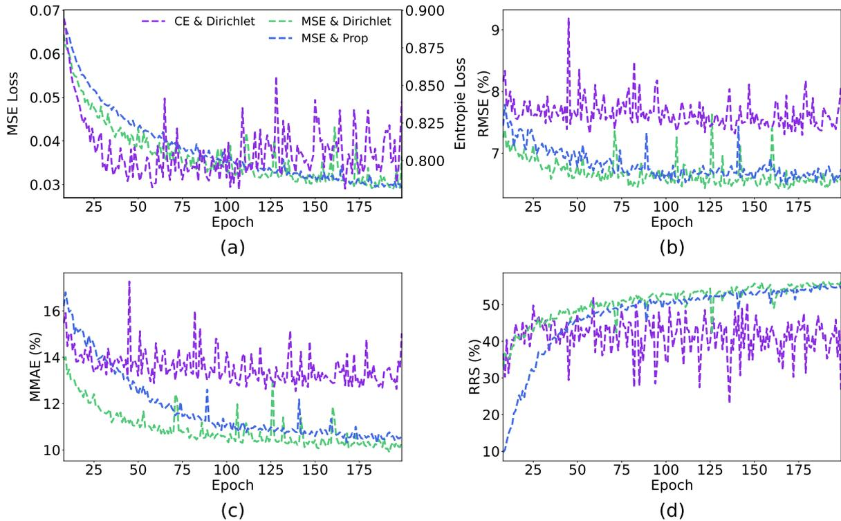
FIGURE 4.16 – Images “MNIST mélange” : (a) Evolution des valeurs des fonctions de perte, l’échelle de gauche correspond aux valeurs des fonctions utilisant l’erreur des moindres carrés (*MSE*, *MSE & Dirichlet* et *MSE & Prop*). Les figures (b), (c) et (d) décrivent les valeurs des mesures (RMSE, MMAE et RRS respectivement) sur l’ensemble de validation au cours des époques d’entraînement.
