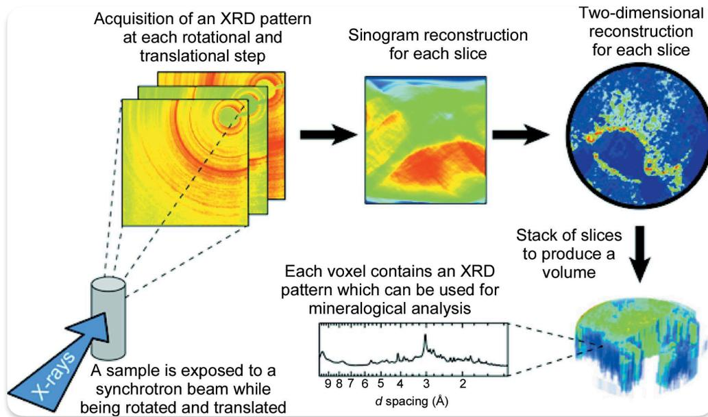
FIGURE 6.1 – Illustration de la procédure pour obtenir les diffractogrammes et les images du jeu de données de tomographie. Extrait de *Deciphering mineralogical changes and carbonation development during hydration and ageing of a consolidated ternary blended cement paste* de Claret *et al.* (CLARET *et al.* 2018).
