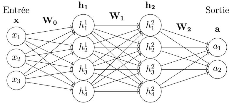
FIGURE 3.1 – Représentation schématique de l’architecture d’un réseau de neurones (FCNN), avec un vecteur d’entrée  $\mathbf{x}$ , deux couches cachées  $\mathbf{h}_1$  et  $\mathbf{h}_2$  et la sortie  $\mathbf{a}$ .
