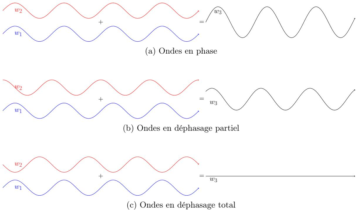
FIGURE 2.5 – Illustration du phénomène de déphasage d’onde à différents niveaux. Partant du cas (a) avec des ondes parfaitement en phase, jusqu’à un déphasage total (c).
