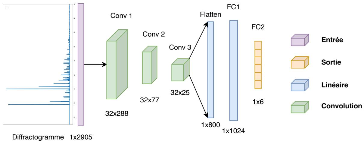
FIGURE 3.4 – Architecture du CNN pour la classification
