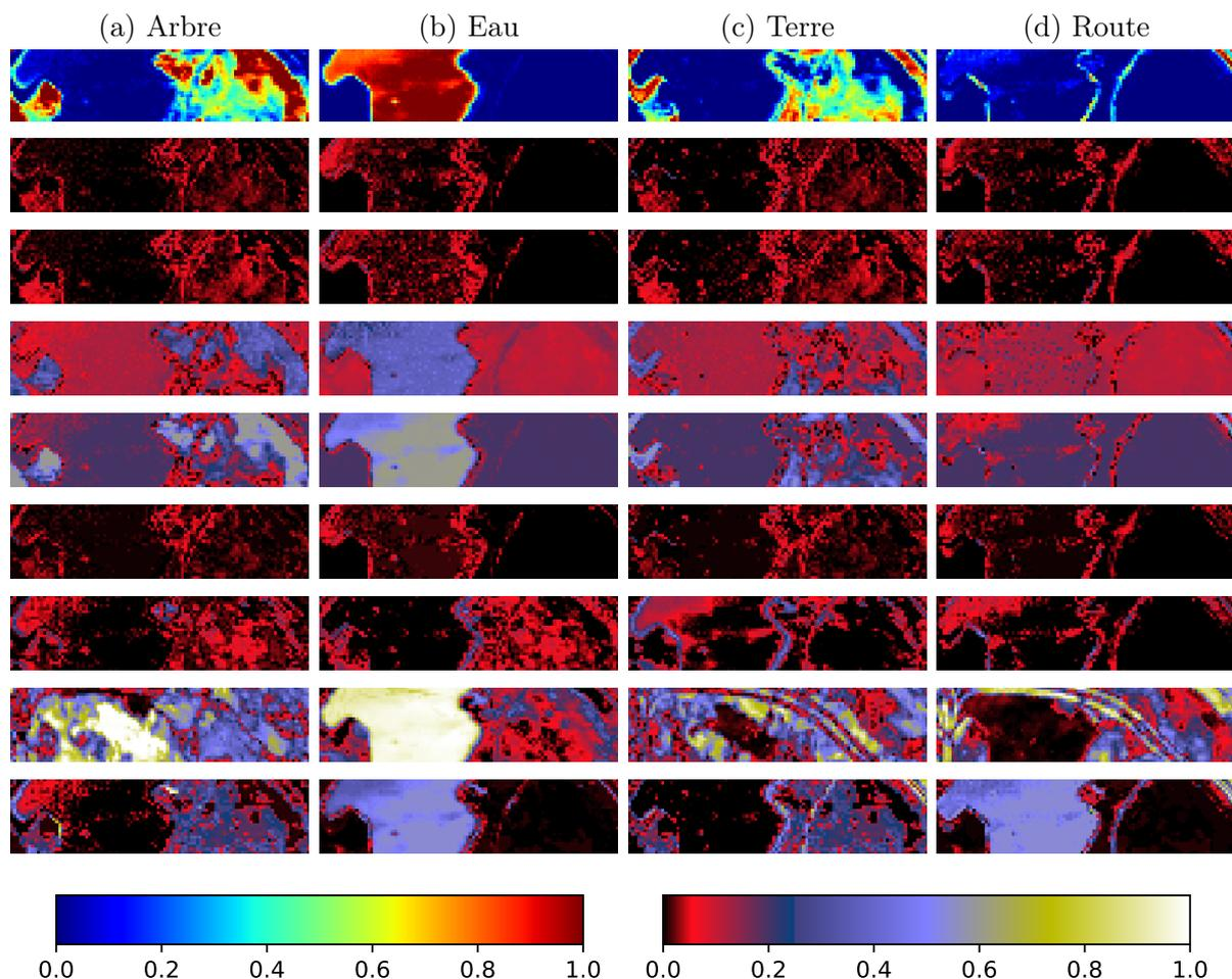
FIGURE 4.10 – Pour chaque classe de Jasper Ridge : Zone test (1<sup>e</sup> ligne) et différence absolue entre la vérité et la prédiction respectivement pour les fonctions : “MSE & DIR” (2<sup>e</sup> ligne), “CE & DIR” (3<sup>e</sup> ligne), “CE & Softmax” (4<sup>e</sup> ligne), “MSE” (5<sup>e</sup> ligne), “MSE & Prop” (6<sup>e</sup> ligne) et méthodes alternatives : SUNSAL (7<sup>e</sup> ligne), UnDIP (8<sup>e</sup> ligne) et HyperAE (9<sup>e</sup> ligne).
