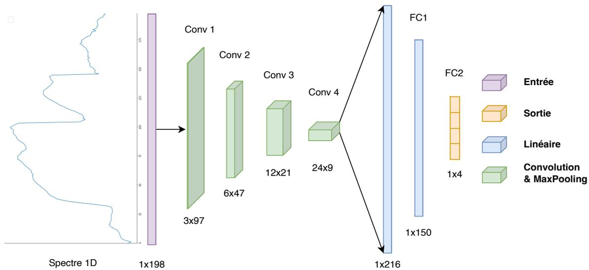
FIGURE 4.7 – Architecture du réseau de neurones convolutif utilisée pour l’inférence de proportions des images hyperspectrales
