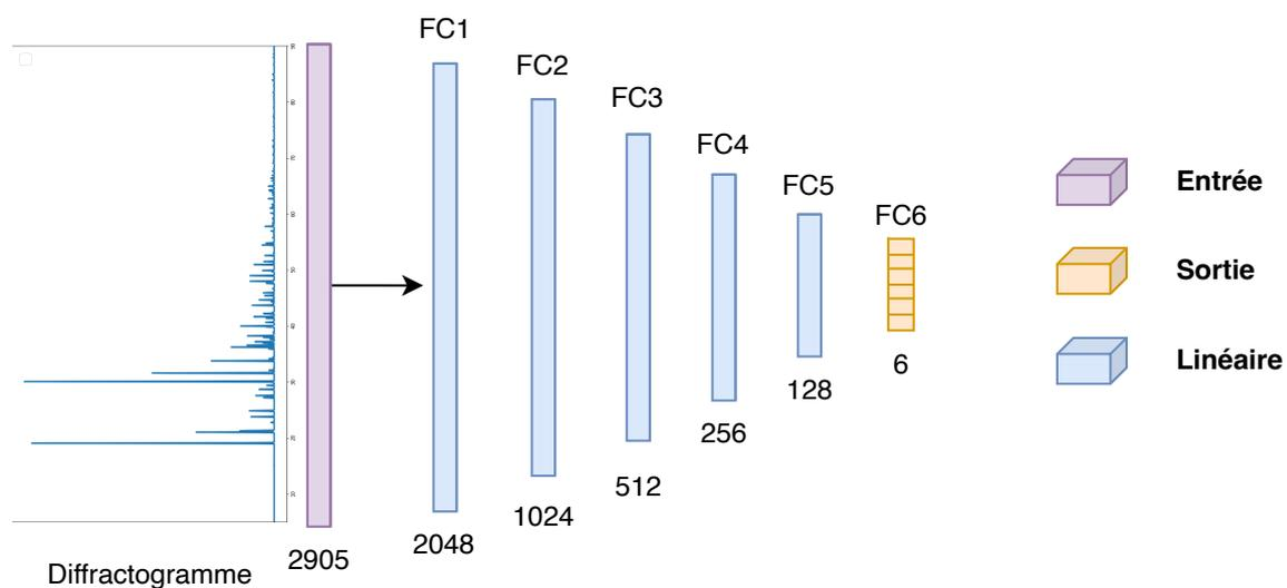
FIGURE 3.5 – Architecture du FCNN pour la classification
