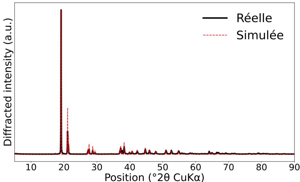
FIGURE 1.1 – Comparaison d’un diffractogramme de Gibbsite réel avec une simulation. Ce signal correspond à l’intensité des rayons X diffractés en fonction d’un angle  $\theta$  (plus d’explications concernant la DRX sont détaillées dans la section 2.2).
