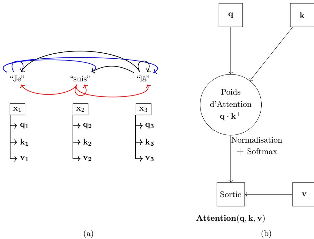
FIGURE 7.2 – (a) Lien entre chaque segment de l’entrée grâce aux vecteurs requêtes ( $\mathbf{q}$ ), clés ( $\mathbf{k}$ ) et valeurs ( $\mathbf{v}$ ) grâce au principe d’**attention**. Les vecteurs  $\mathbf{q}, \mathbf{k}, \mathbf{v}$  sont obtenus avec partir d’une opération linéaire à partir des vecteurs  $\mathbf{x}_i$ . (b) Schéma simplifié du calcul des scores d’**attention**.
