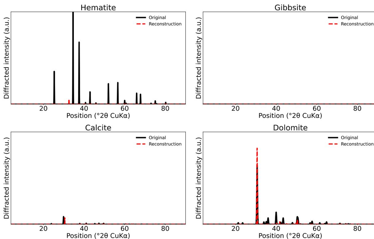
FIGURE 8.2 – Comparaison des signaux  $C_i$  reconstruits par l’auto-encodeur avec ceux originaux. Comme pour la figure 8.1, la donnée est synthétique et composée de 4% de Calpajencite, 68% de Dolomite et 27% d’Hématite.
