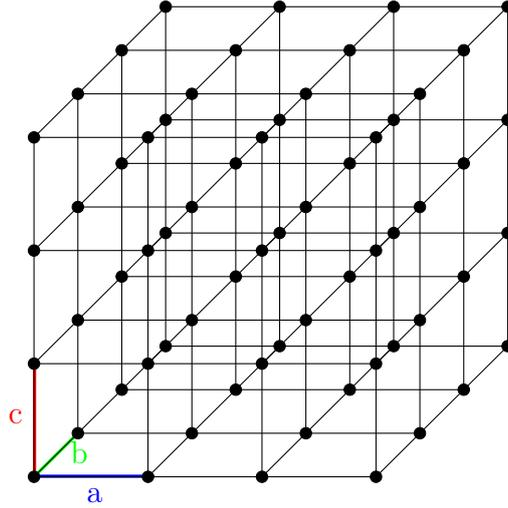
FIGURE 2.3 – Exemple d’un réseau de Bravais
