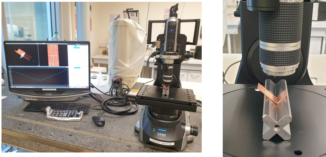
FIGURE 4.10 – Illustration du scan 3D d’une pièce réalisée avec un microscope numérique KEYENCE VHX-7000 équipé d’un objectif VH-Z20R pour un grossissement de 100
