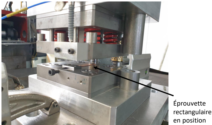
FIGURE 4.7 – Positionnement d'une éprouvette rectangulaire sur l'outil avant mise en forme
