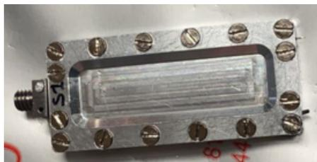
Figure 4.1 – Cellule plate en aluminium utilisée pour les mesures QENS sur FOCUS. L'échantillon se trouve au centre de cette cellule.
