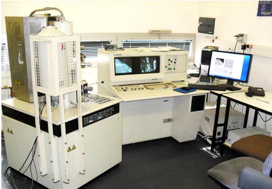
Figure A. 1 Dispositif expérimental MEB Hitachi S4500 (PROMES CNRS) Perpignan.
