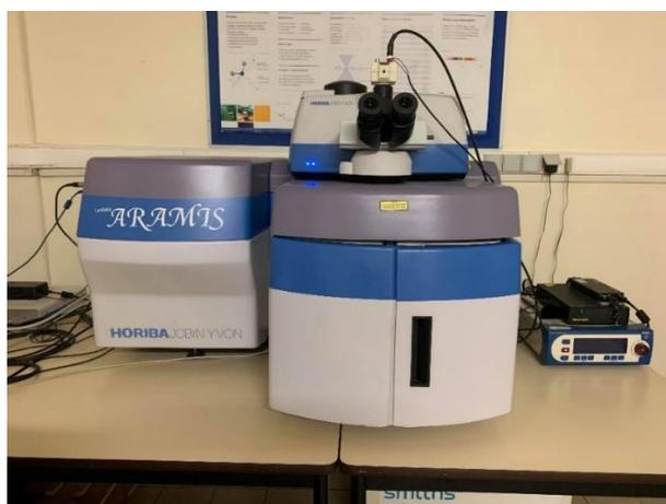
Figure A. 7 Dispositif expérimental Raman LabRAM ARAMIS Horiba (université de Montpellier).
