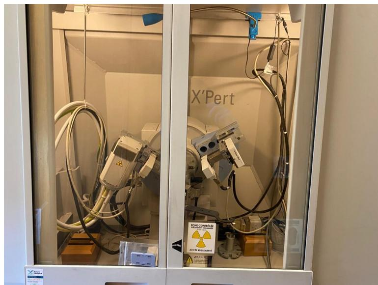
Figure A. 5 Appareillage de diffraction de rayons X Philip X'PERT (Université de Montpellier).
