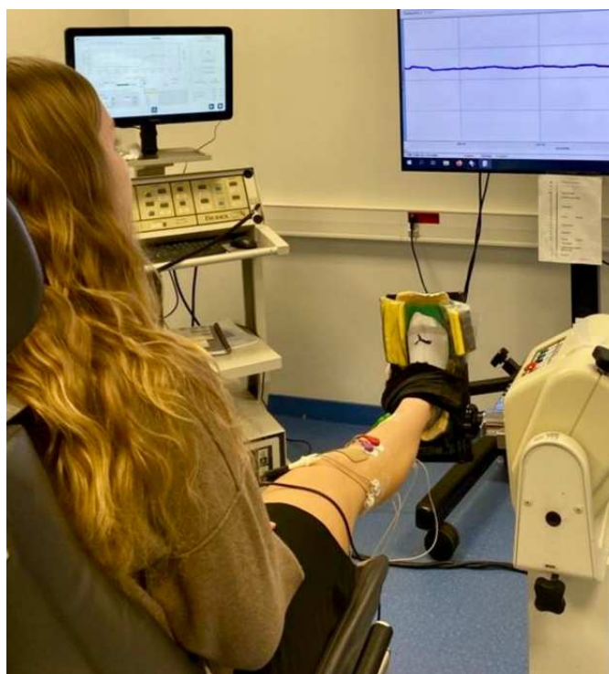
Figure 19. Placement du sujet sur le dynamomètre pour l'évaluation des fléchisseurs plantaires.
