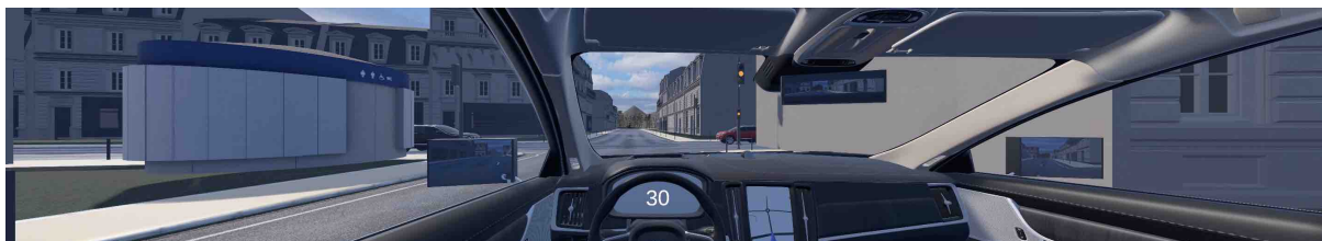
(a) Vidéo montrant le véhicule passant un feu orange, car il a détecté une moto tournant dans l'intersection qu'il vient de passer et dans l'angle mort du passager.
