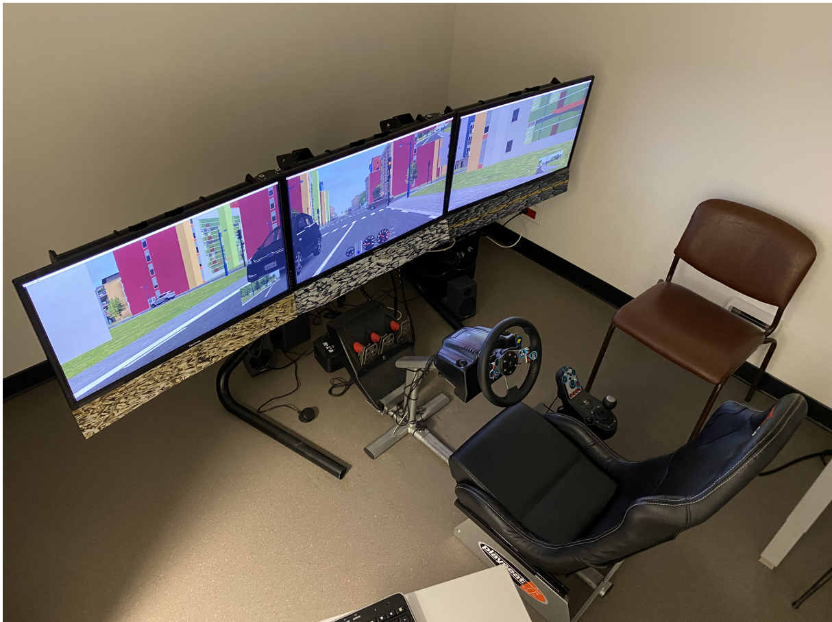
Figure II.23 – Simulateur de conduite utilisé pour l'expérimentation. 3 écrans offrent une vision à 80° de la situation. Le volant et les pédales permettent une meilleure immersion.
