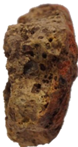
Figure 37 : Scorie de réduction de tétraédrite ocre et poreuse découverte sur le site néolithique du Planet (Aveyron). Ces scories ne sont ni vitrifiées ni sombres et denses comme le supposerait la classification de Hoffmann et Miller, 2014. Image modifiée d'après une photographie par Emmanuel Dransart.
