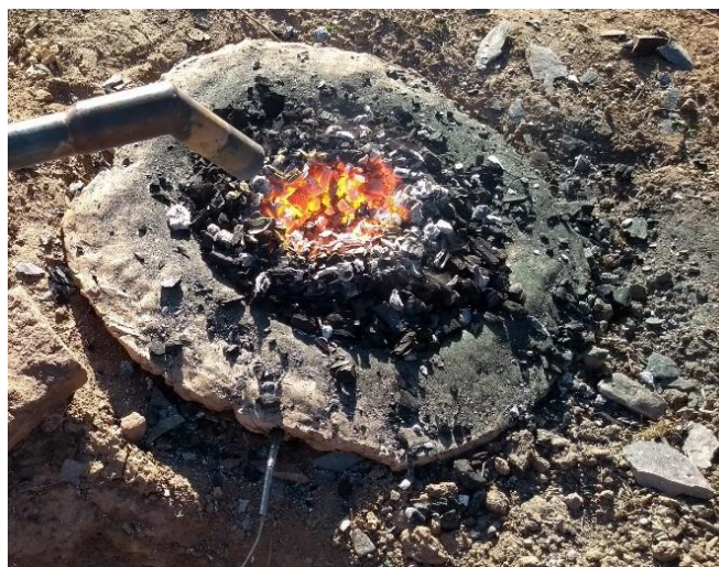
Figure 29 : Expérimentation de fonte de bournonites sous atmosphère réductrice dans une reconstitution de four-cuvette sur le site du Planet. Photographie : Céline Tomczyk.
