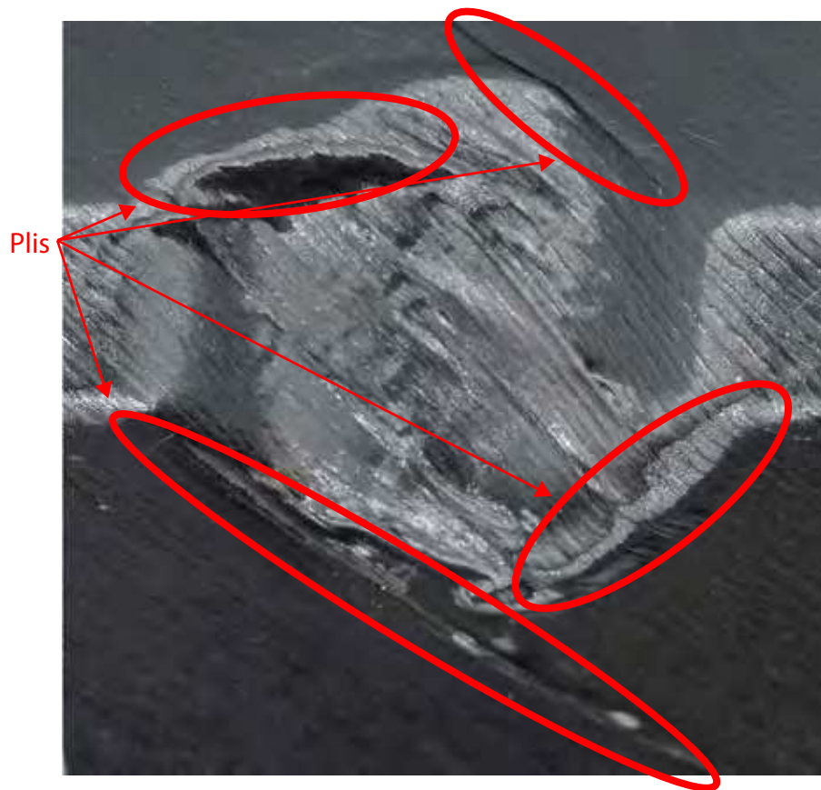
FIGURE 5 – Exemple de défauts de dépose induits par une contre-forme
