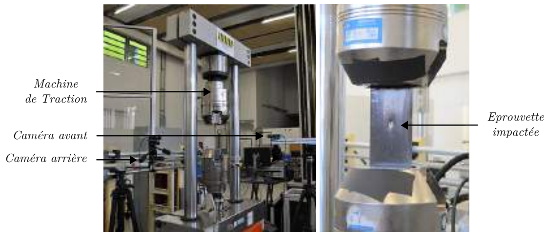
Figure I.7 – Conditions expérimentales de l'essai de traction sur éprouvette impactée
