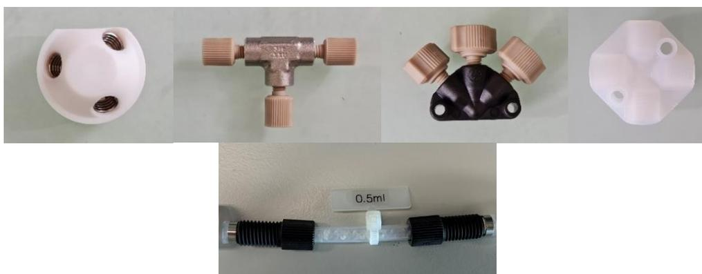
Figure 5 : Mélangeurs utilisés en chimie en flux (de gauche à droite : Y, T ancre, croix, tube avec obstacles intégrés)
