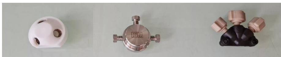
Figure 50 : Mélangeurs utilisés en M1, de gauche à droite Y, T et ancre
