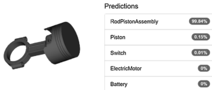
Figure 24 : résultats de classification d'un modèle CAO par prédictions d'un CNN (Dekhtiar et al., 2018)
