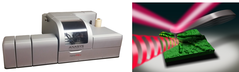
FIGURE 4.5 – Dispositif du nanoIR2 (d'après une présentation de A. DAZZI).
