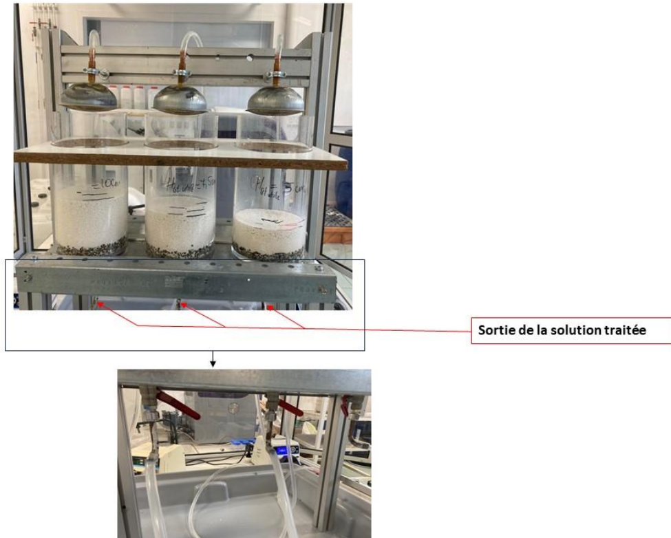
Figure 20 : Montage expérimental des essais d'adsorption en colonne
