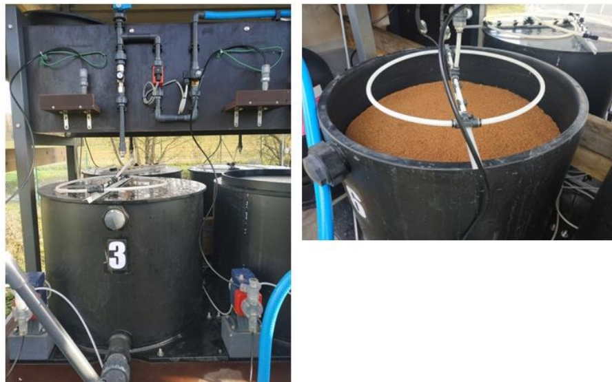
Figure 21 : Réacteurs du pilote de MAANEO
