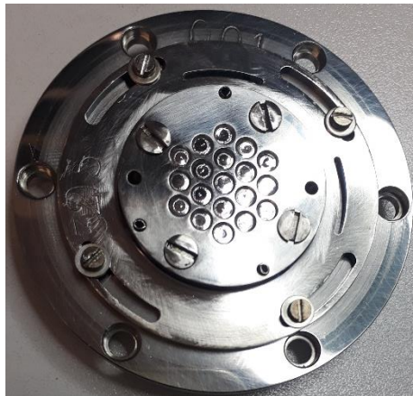
Figure 28 : Porte-échantillon de 19 lames – chaque disque au centre a un diamètre de 3 mm
