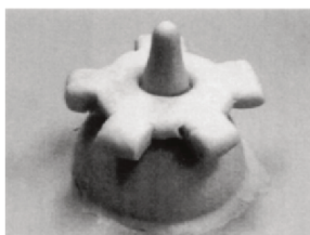
Figure I-37. Microturbine fonctionnelle fabriquée à partir de la résine Nopcure 800. Adapté de [127]
