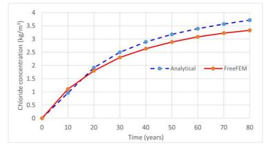
Figure 2: Validation du modèle pour la pénétration unidimensionnelle du chlorure
