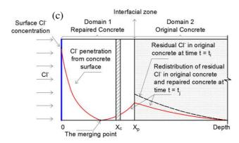
**Figure 5:** (a) Profil des chlorures immédiatement avant la réparation, (b) Profil des chlorures immédiatement après la réparation à  $t = t_i$ , (c) Profil des chlorures après la réparation à  $t = t_j$  ( $t_j > t_i$ )
