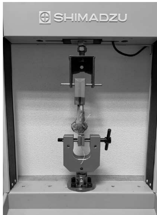
Figure 45. Configuration biomécanique d'un échantillon tibial (1G) implanté placé dans la machine d'essai mécanique.
