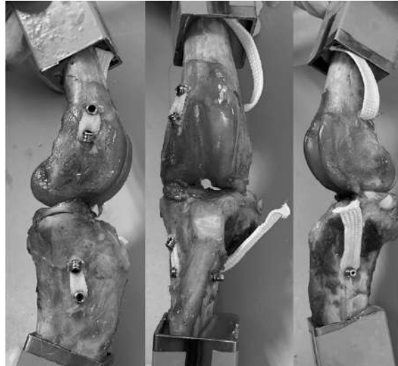
Figure 22. Visualisation finale de la procédure d'implantation permettant la stabilisation passive intra-articulaire du grasset à l'aide de l'implant synthétique en UHMWPE et fixé par quatre vis d'interférence.
