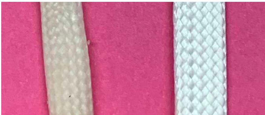
Figure 29. Photo de l'implant synthétique Novalig 8000 post-essai biomécanique à gauche et neuf à droite.
