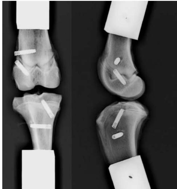
Figure 37. Radiographie (de face à gauche et de profil à droite) post-essai en condition de fatigue de l'échantillon 16D
