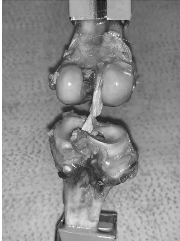
Figure 25. Photo en vue postérieure de l'échantillon N1R post-essai permettant de visualiser la rupture du LCC au niveau de son insertion tibiale
