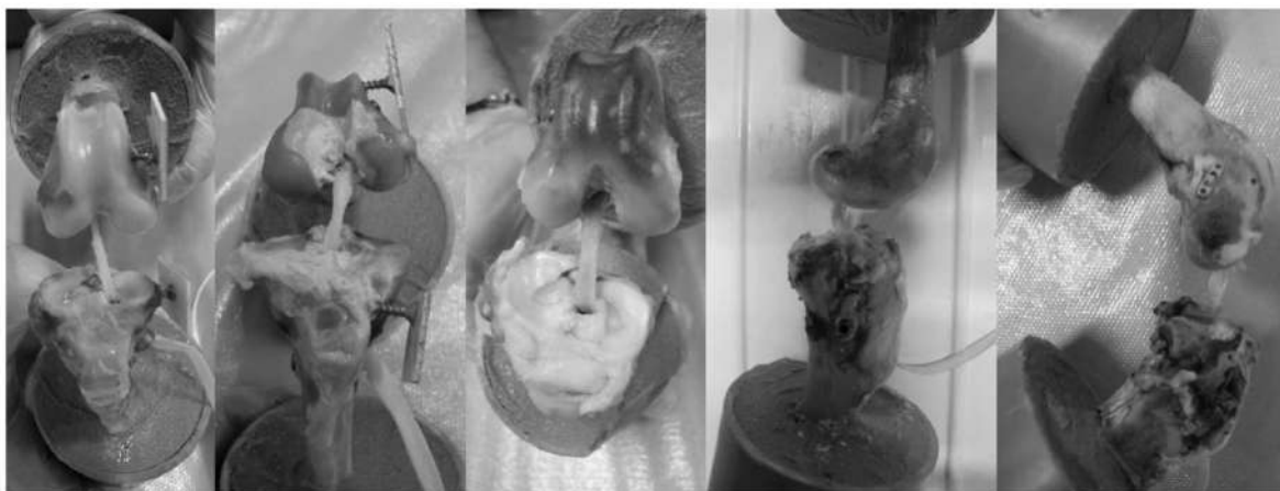
Figure 54. Photos de l'endommagement / abrasion de l'implant en UHMWPE post-essais de gauche à droite : N6D ; PE2 ; N4D ; N5G et N3G.
