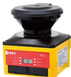
(a) Le LiDAR de sécurité IDEC SE2L
