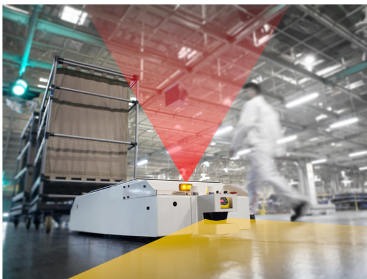
Figure 6.1 – Illustration du concept de la séparation de l'espace de navigation (détection d'obstacles via un LiDAR sur le plan horizontal jaune) de l'espace de localisation (détection d'amers via une caméra sur le plan vertical rouge).
