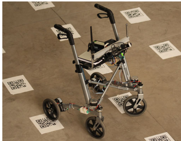
Figure 2.9 – Un système de localisation visuelle à base de QrCodes placés au sol (tiré de [35]).
