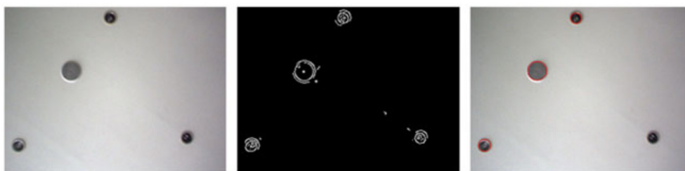
Figure 4.13 – Détection des cercles sur le plafond dans [134].
