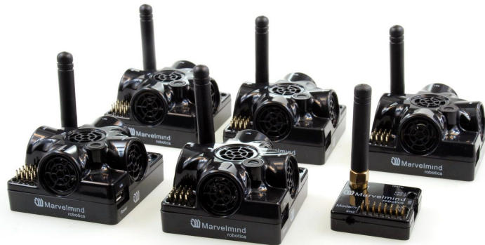
Figure 2.11 – Composantes du système de localisation ultrasonique centralisée Marvelmind Indoor GPS (tirée de [50]).
