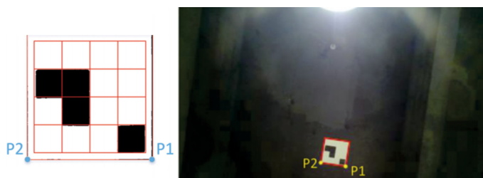
Figure 4.15 – Marqueur placé sur le plafond dans [138].
