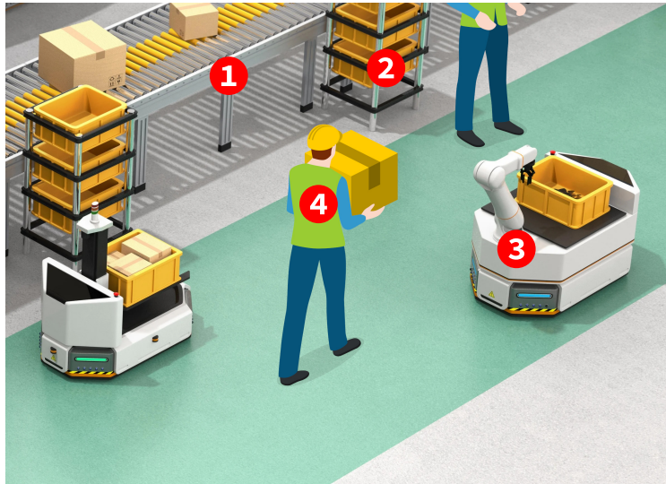
Figure 2.7 – Illustration d'un robot évoluant dans un environnement dynamique en présence : (1) d'objets statiques permanents, (2) d'objets statiques temporaires, (3) d'objets dynamiques prédictibles (autres robots), et (4) d'objets dynamiques imprédictibles (humains).
