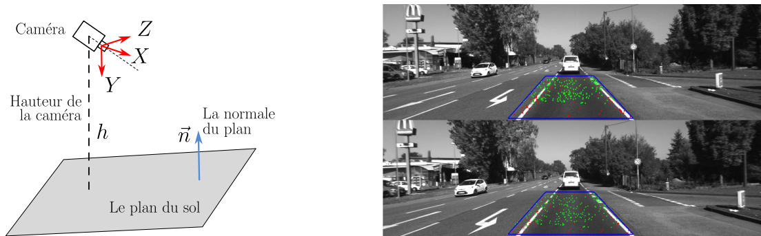
(a) Géométrie du plan au sol (b) La zone d'intérêt avec les caractéristiques extraites
