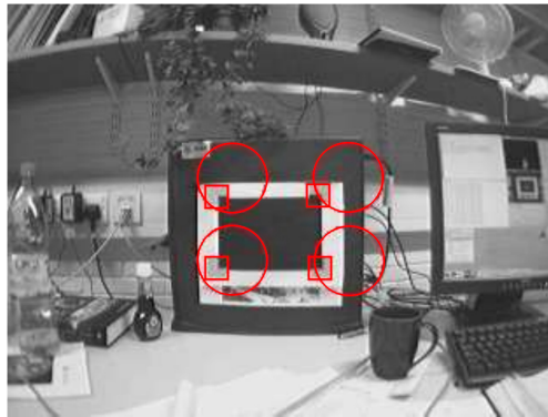
Figure A.2 – Dans la MonoSLAM, une mise en correspondance de quatre caractéristiques connues est réalisée à l'initialisation. Les carrés représentent les caractéristiques détectées et les cercles reflètent l'incertitude attribuée à l'estimation de la position de départ de la caméra (tirée de [66])
