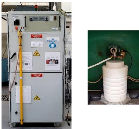
**Figure 20** : Photo du générateur des champs électriques pulsés (Basis power electronics) à gauche, avec sa chambre cylindrique de traitement à droite.
