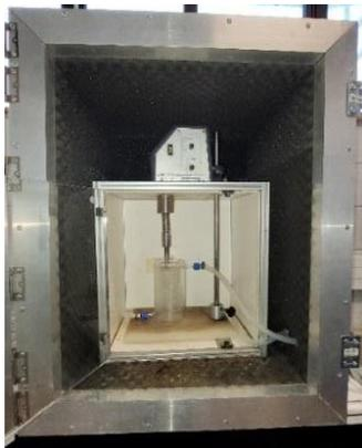
**Figure 19** : Photo de l'ultrasonicateur (UP-400S, Hielscher GmbH)
