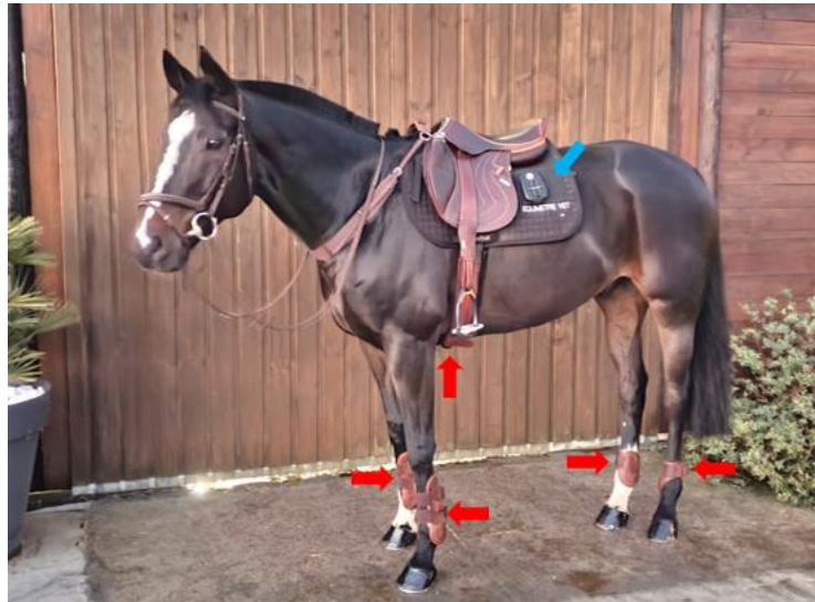
Figure 36 : Equipement du cheval lors de ses entraînements. Les flèches rouges indiquent la localisation des IMUs dans l'équipement du cheval. La flèche bleue indique le système cardiofréquencemètre & GPS EQUIMETRE®.
