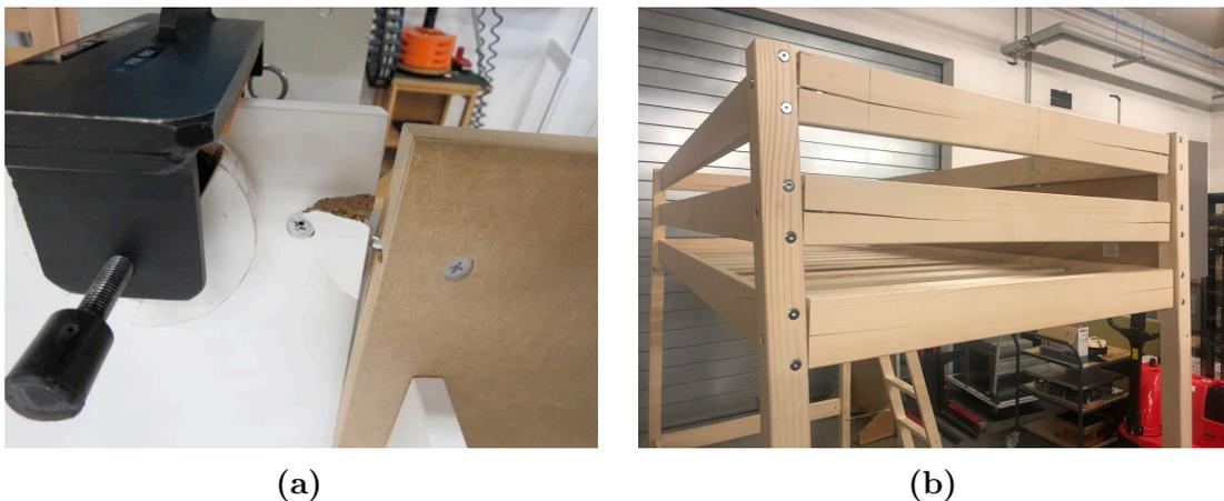
**FIGURE 1** – Deux modes de rupture les plus fréquents : (a) arrachement transversal d'un panneau de particules et (b) fissuration longitudinale d'une traverse en épicea.
