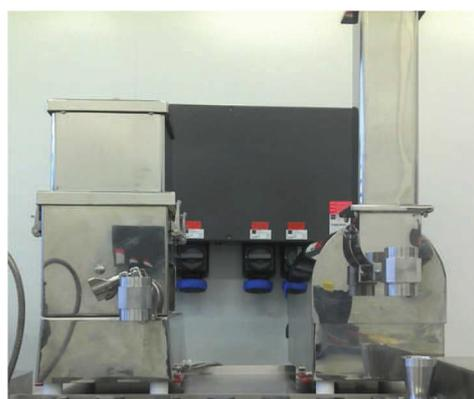
Figure 19 : Doseurs gravimétriques associés à l'extrudeuse
