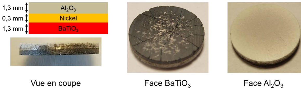
Figure V.2-2 Images d'un multicouche \text{Al}_2\text{O}_3/\text{Ni}/\text{BaTiO}_3 fritté à 1150°C avec un diamètre 20mm et une épaisseur de 2,9 mm
