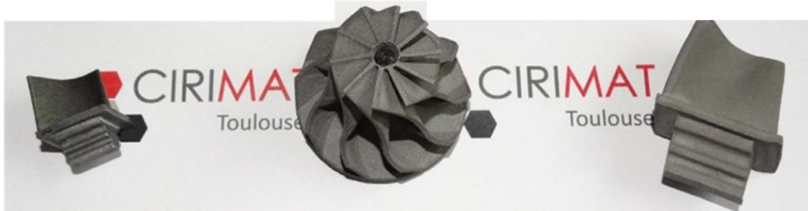
Figure I.3-6 formes Exemples de formes complexes obtenues par SPS [46]
