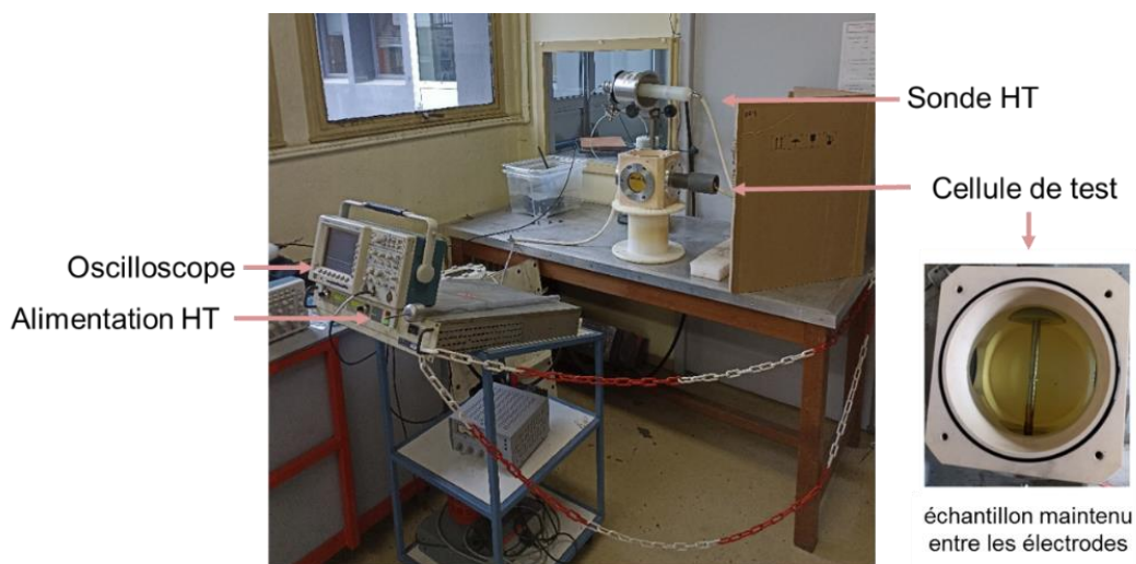
Figure II.6-1 Montage du banc de claquage diélectrique
