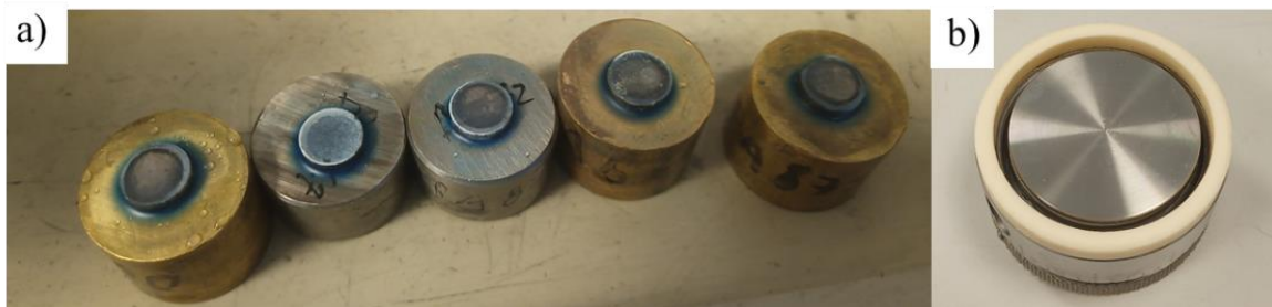
Figure II.4-1 a) Échantillons fixés avec de la cire sur des plots en inox et en laiton b) Accustop avec son anneau en alumine
