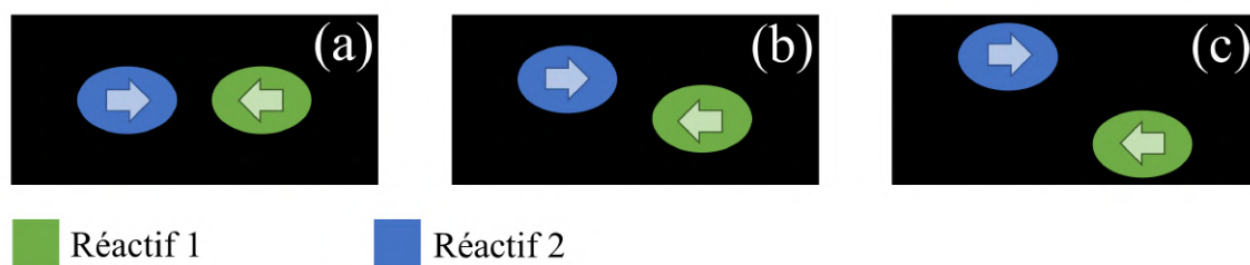
FIGURE 2.26 – Exemples d'éléments d'injection de type doublet : (a) jets impactants, (b) jets semi-impactants et (c) jet non-impactants cisailés.
