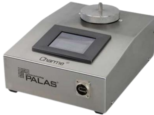
Figure II.20 : Électromètre pour aérosol (Charme, Palas, Allemagne).
