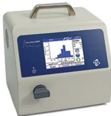
Figure II.13 : Compteur à mobilité électrique de particules NanoScan (modèle 3910, TSI, USA).
