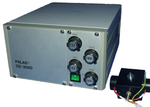
Figure II.15 : Neutraliseur de particules par décharge couronne (CD2000, Palas, Allemagne).
