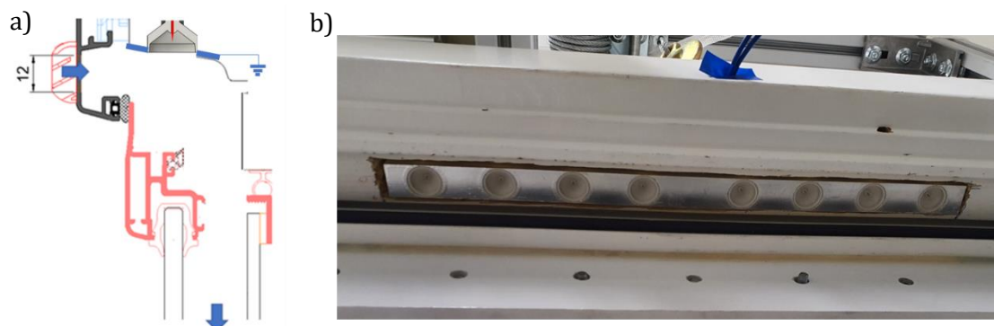
Figure II.7 : Ioniseur à aiguilles en entrée (Ae) : a) schéma de son intégration dans la fenêtre, b) photo.
