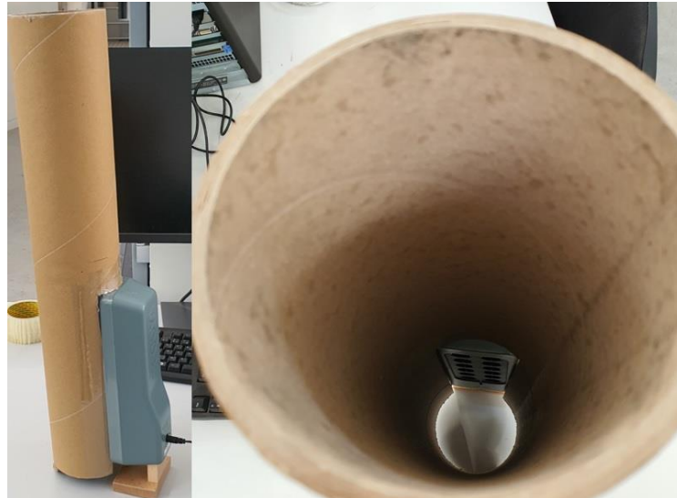
Figure IV.12 : Vue de face et de dessus du conduit par lequel sont injectées les particules chargées d'alumine et d'encens dans la chambre d'essai
