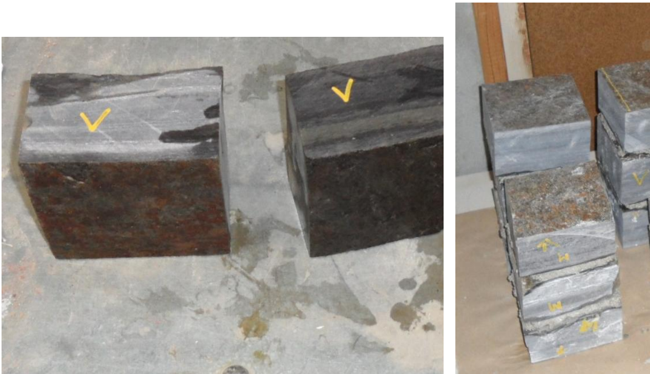
Figure 4.23 : A gauche : Blocs de schiste après découpe ; A droite : Triplets de blocs de schistes assemblés
