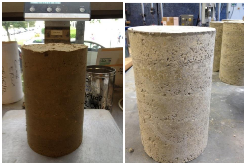
Figure 3.6 : Une éprouvette avant le surfaçage (à gauche) et une éprouvette après le surfaçage (à droite)
