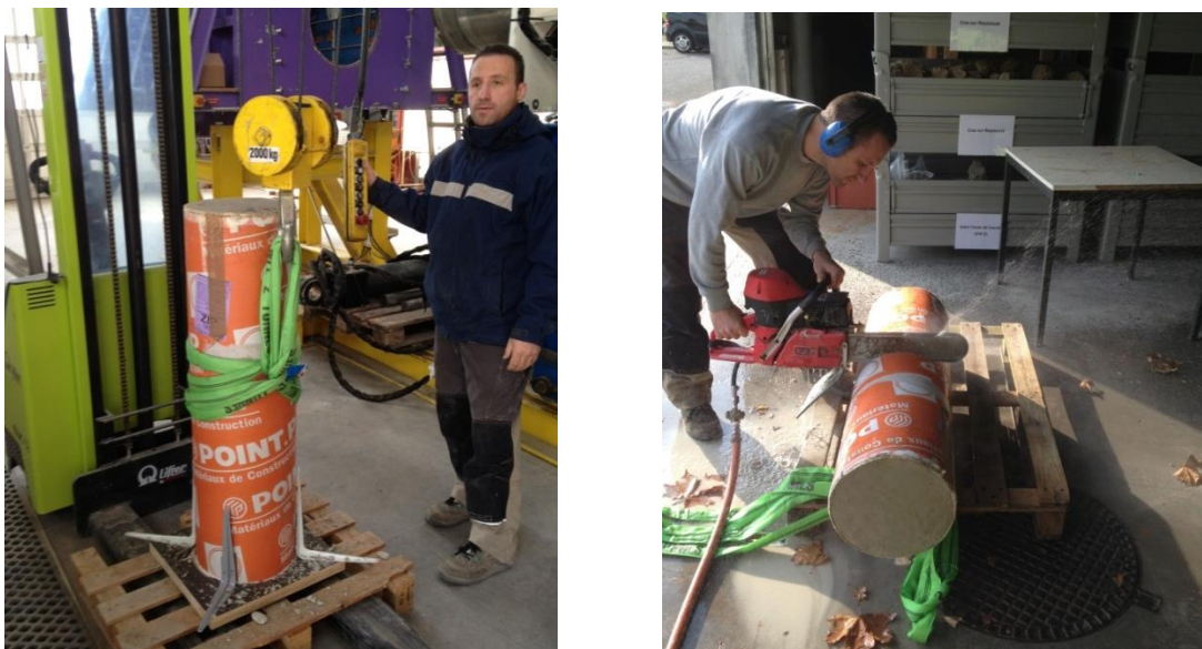
Figure 3.33 : Manipulation des grosses éprouvettes par un élévateur électrique (à gauche) et à droite, la découpe par une tronçonneuse (à droite).
