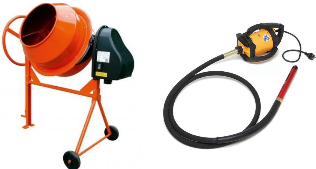
Figure 3.20 : Matériels utilisés pour fabriquer des éprouvettes du matériau terre coulée une bétonnière à gauche et une aiguille vibrante à droite,
