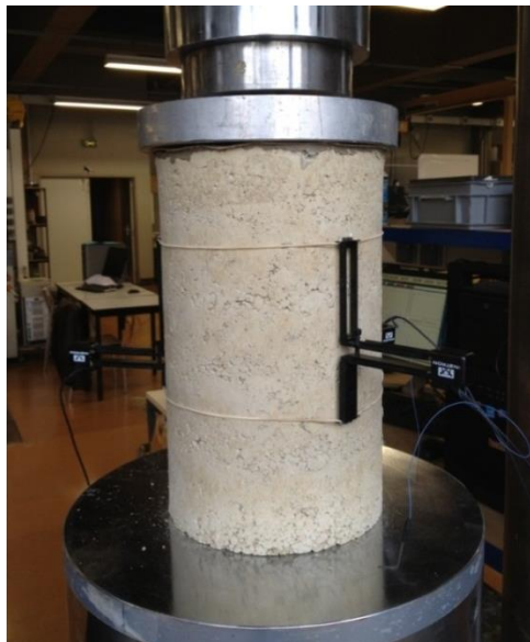
Figure 3.7: Dispositif sur une éprouvette. Les extensomètres déterminent la déformation longitudinale de l'éprouvette
