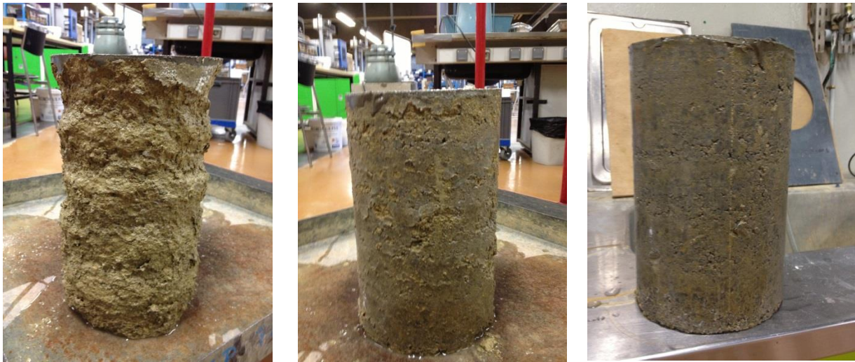
Figure 3.15 : Les éprouvettes de la terre de Levens compactée stabilisée après 24h d'immersion dans l'eau. À gauche, stabilisée à 4% de ciment ; au milieu : 6% et à droite : 8% de ciment
