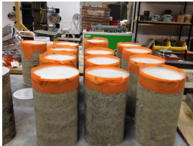
Figure 3.5 : Surfaçage des éprouvettes par une couche de ragréage
