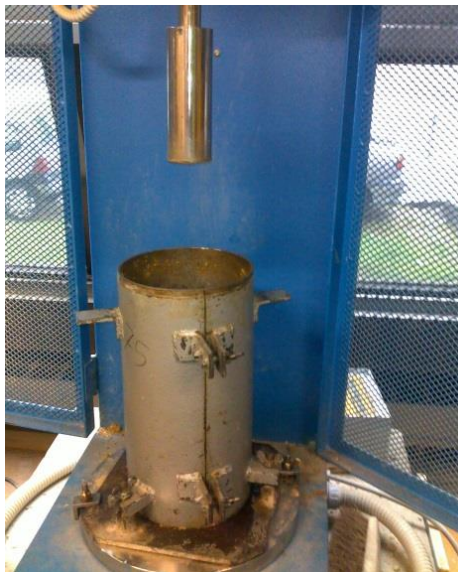
Figure 3.2 : La machine de compactage dynamique et le moule CBR modifié
