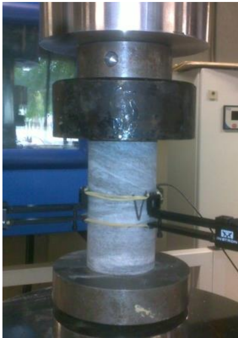
Figure 4.18: Essai de compression simple avec des extensomètres mesurant la déformation
