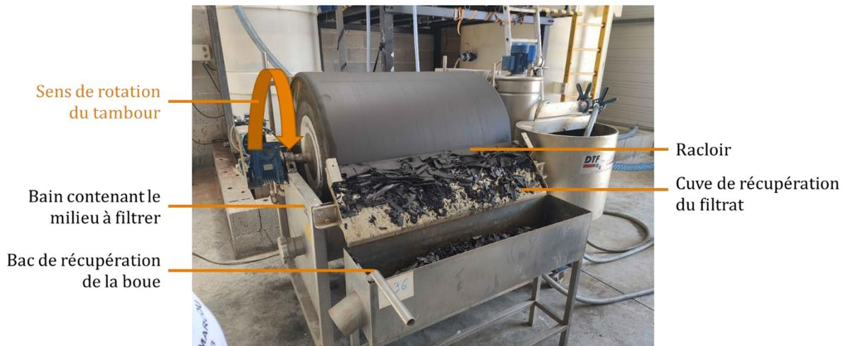
Figure 4-1 : Photographie du filtre rotatif utilisé pour la production de la boue STEMA.
