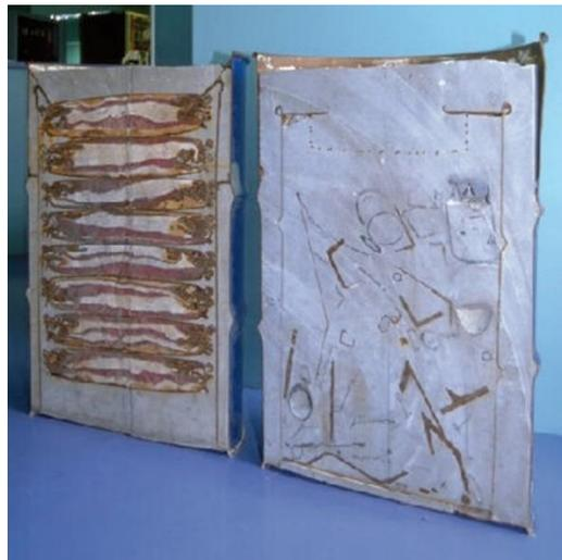
**Figure 2-3** : Coupe de colis de déchet métallique enrobé en matrice cimentaire sur le site de Marcoule. Source photo : Agence Nationale pour la gestion des Déchets Radioactifs (ANDRA).
