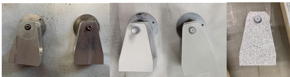
Figure 186 – Mouchetis sur le montage d'essais
