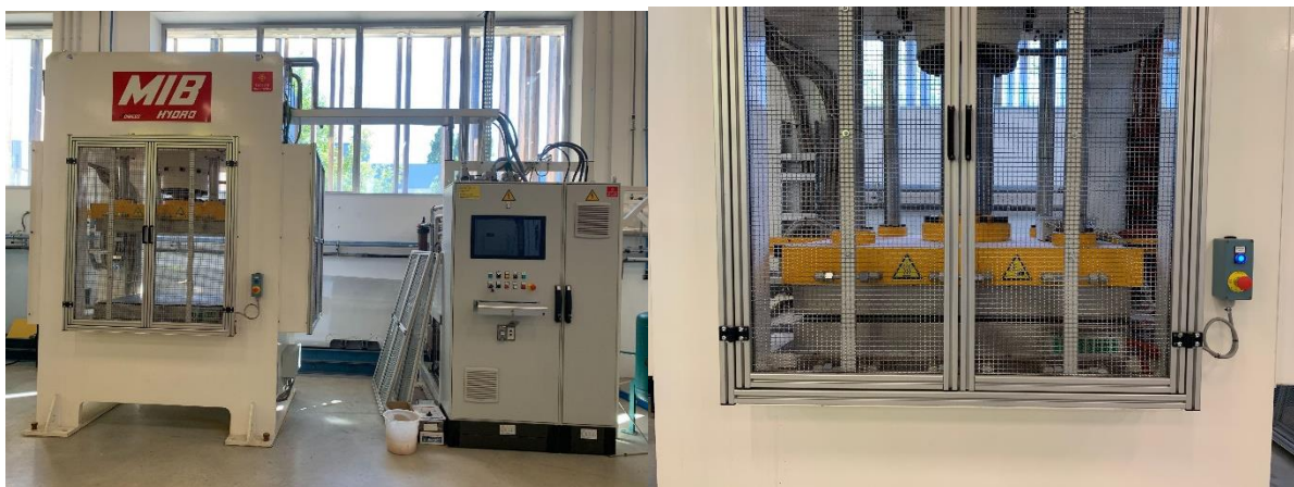
Figure 175 – Presse hydraulique MIB Hydraulique PA 200 présente à l'ICA
