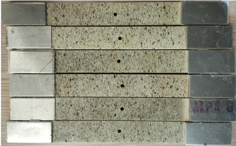
Figure 140 – Éprouvettes de traction QI trouées
