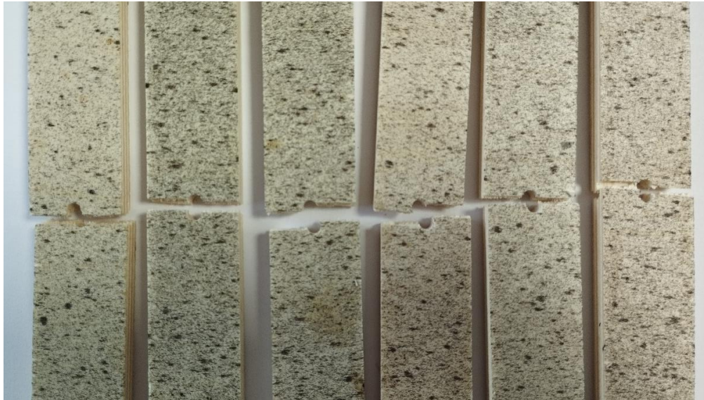
Figure 154 – Facies de rupture d'éprouvettes CP trouées
