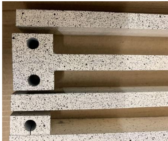
Figure 115 – Mouchetis sur les éprouvettes
