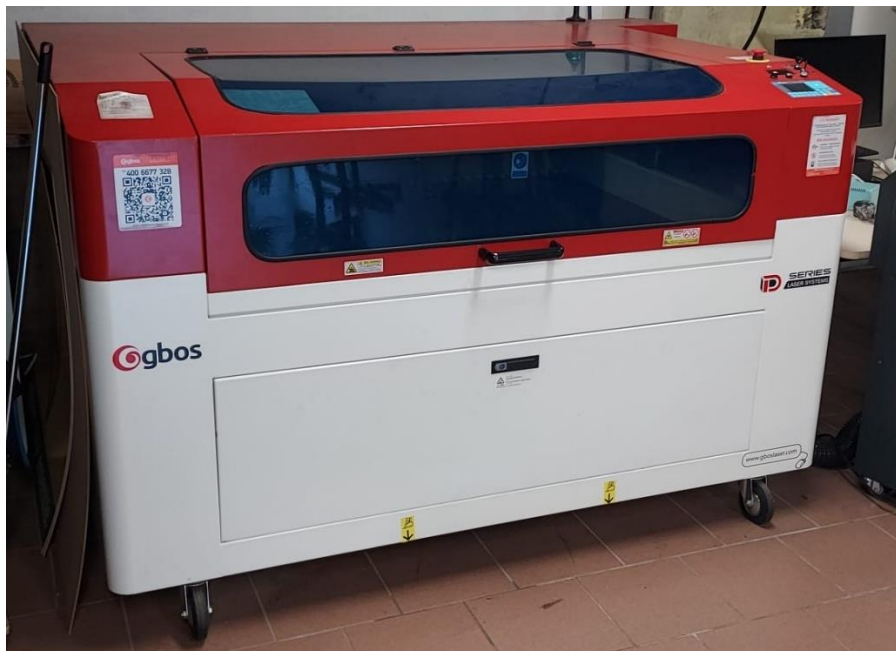
Figure 172 – Machine de découpe laser CO 2 GBOS Série D
