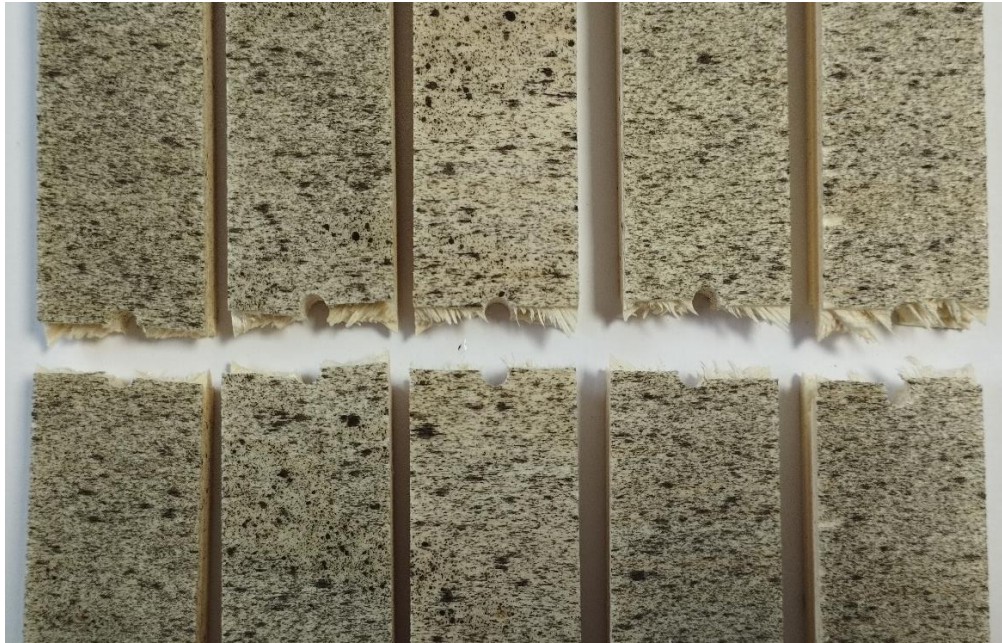
Figure 156 – Facies de rupture d'éprouvettes QI trouées
