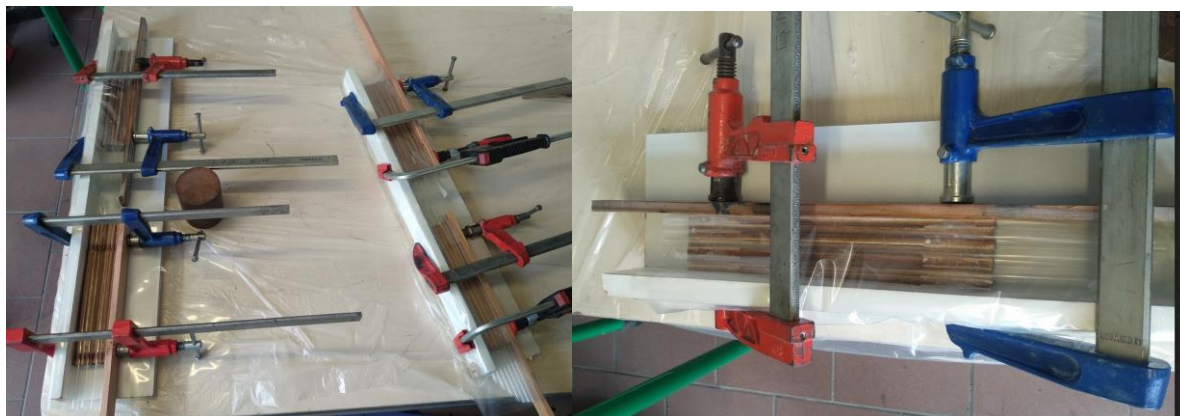
Figure 181 – Collage des talons sur des éprouvettes de traction
