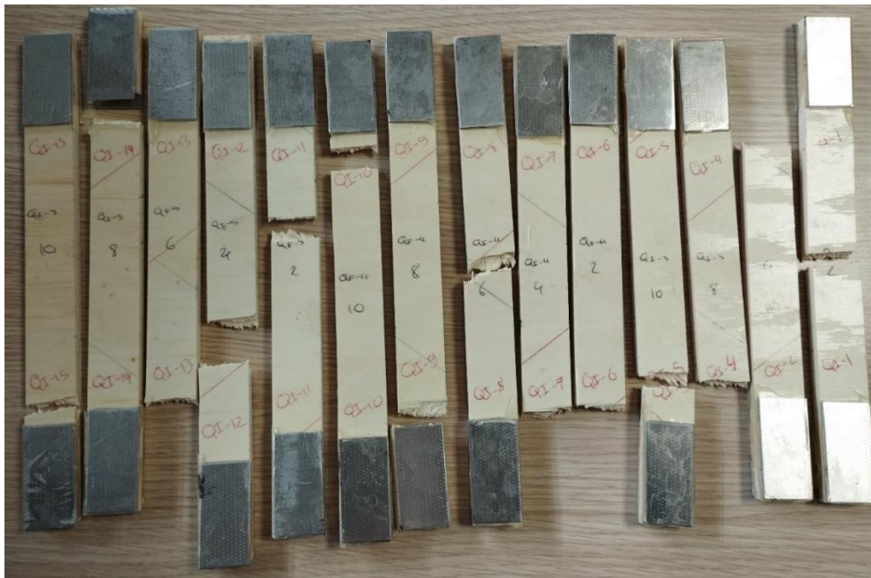
Figure 151 – Facies de rupture d'éprouvettes QI
