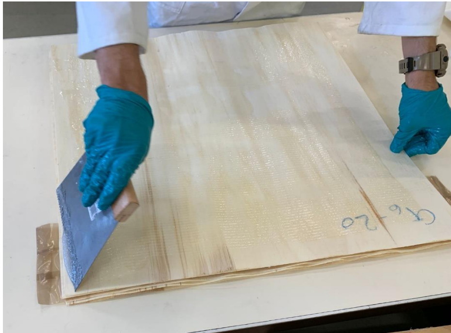
Figure 174 – Homogénéisation de la répartition de la colle à l'aide d'une spatule crantée
