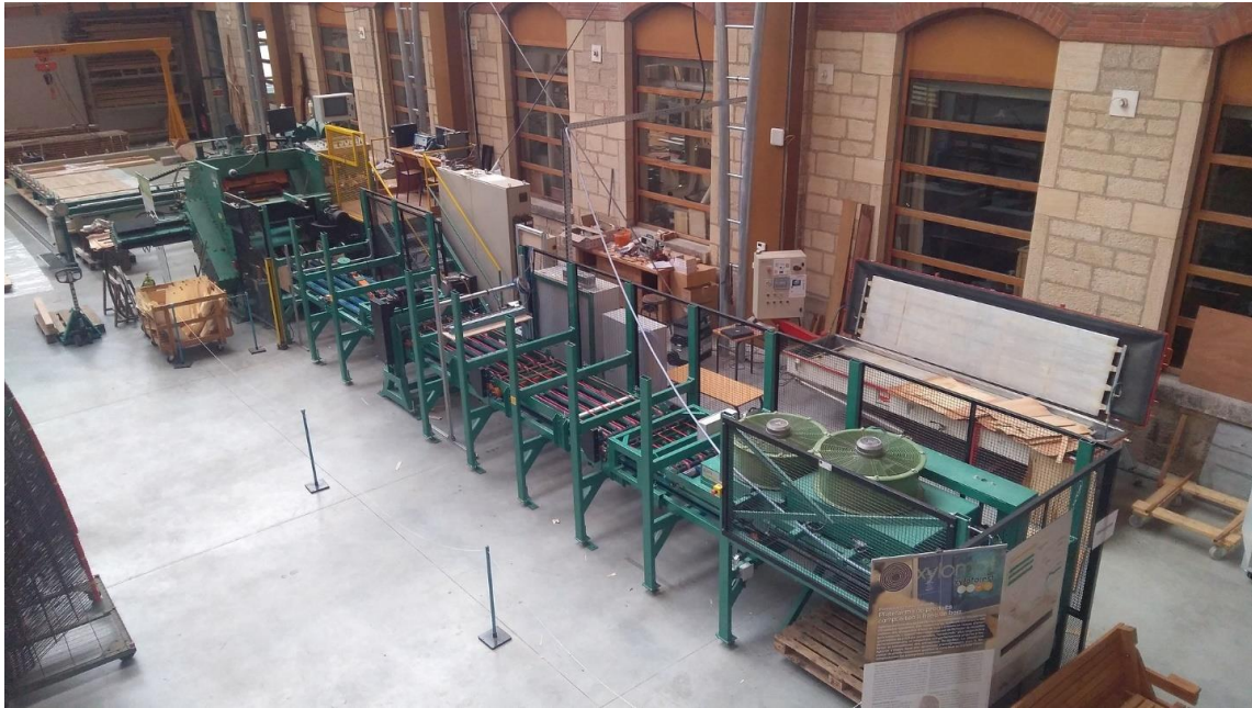
Figure 33 – Plateforme de déroulage de billons du LaBoMaP (ENSAM, Cluny, France)
