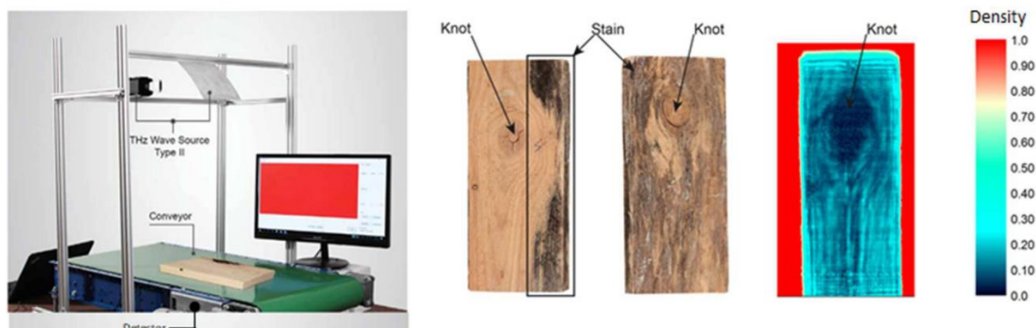
Figure 3 – Scanner de densité TéraHertz appliquée au bois (TeraSense Corp.)
