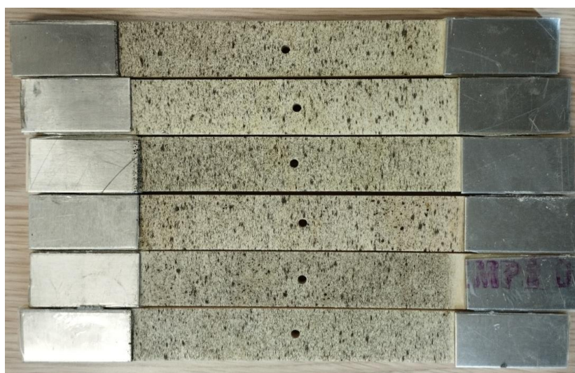
Figure 184 – Mouchetis sur des éprouvettes de traction trouées
