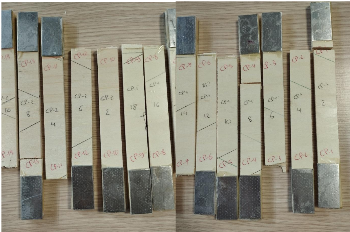
Figure 148 – Facies de rupture d'éprouvettes CP
