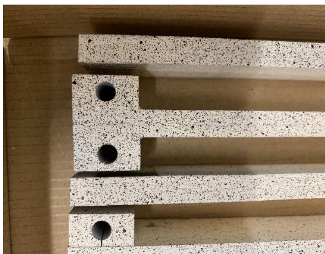
Figure 185 – Mouchetis sur des éprouvettes DCB
