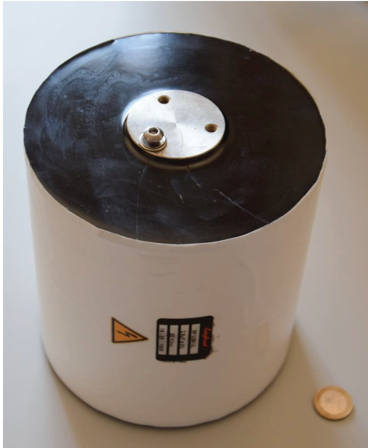
Figure II.20 — Vue d'un des condensateurs du banc de stockage d'énergie. Condensateur au polypropylène métallisé de capacité de 2,6 \mu F et de tension nominale de 20 kV.
