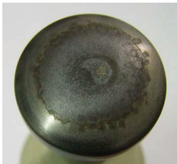
Figure I.31 — Anode d'un éclateur après plusieurs essais [62].
