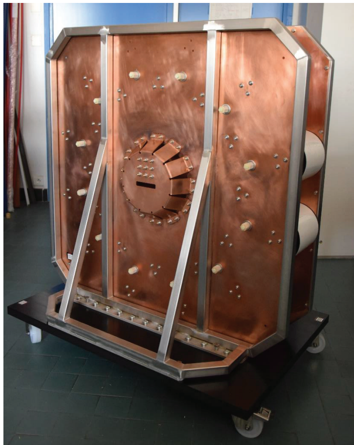
Figure II.22 — Banc de condensateurs pour l'EMP.
