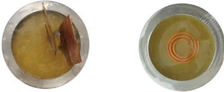
Figure V.2 — Inducteur encapsulé dans une résine époxy. À gauche, l'inducteur en vue du dessus et à droite en vue du dessous.
