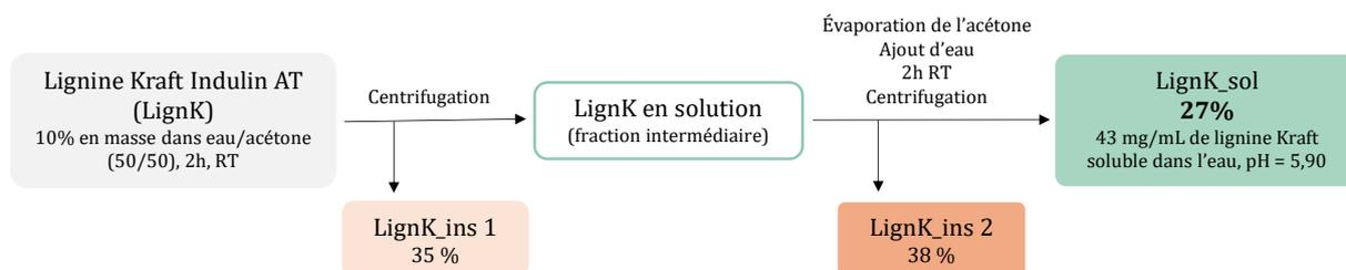
Figure V-46 : Protocole suivi pour l'obtention d'une fraction soluble de lignine Kraft par fractionnement.
