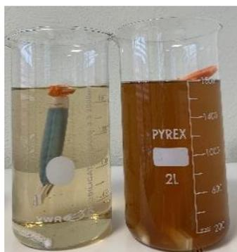
Figure V-22 : Photographies de baignoires de dialyse. La poche du bécher de gauche contient une lignine traitée par la BOD tandis que la poche du bécher de droite contient un contrôle sans enzyme. Les poches de dialyse ont des pores de 100 kDa.
