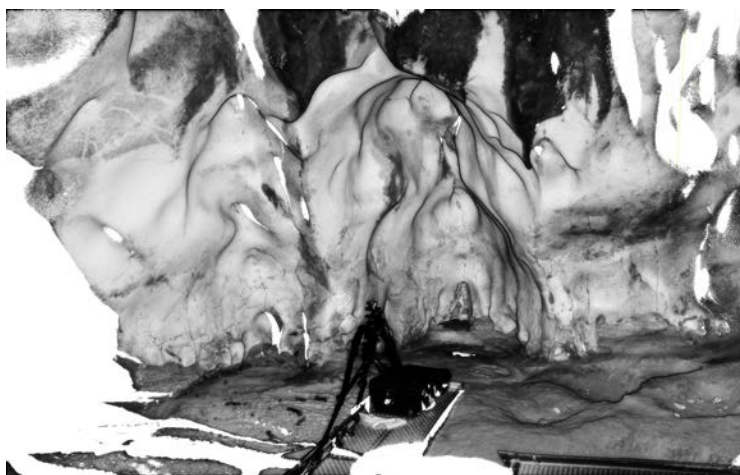
FIGURE 4.15 – Nuage de points 3D du panneau des Chevaux, obtenu avec un scanner TLS. Les niveaux de gris de l'intensité du signal sont sans rapport avec la couleur de la paroi. [Données provenant de Perazio Engineering, ministère de la Culture].
