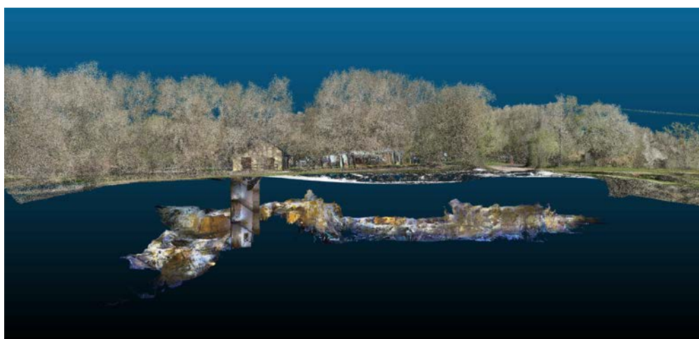
FIGURE 1.14 – Grotte de Foissac : numérisation multiscalaire et multicateur. Il s’agit de l’assemblage des relevés Lidar HD de l’IGN, par un drone, et par un scanner terrestre avec un cheminement allant de l’extérieur jusqu’à l’entrée protohistorique. En haut : vue oblique montrant les emprises des acquisitions. En bas : vue de côté montrant le puits d’accès actuel et le déroulé de la grotte. [Données provenant de la société 3DSI].
