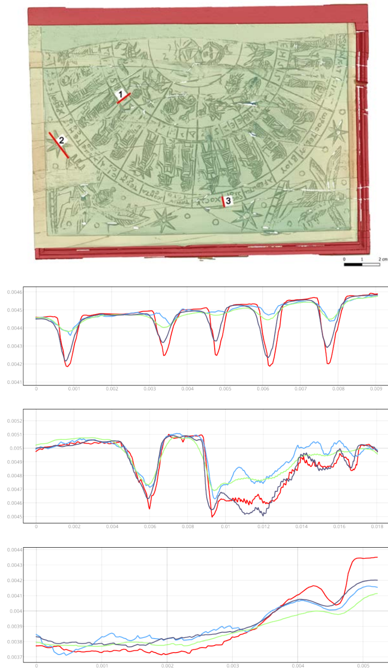
FIGURE 2.15 – En haut : localisation de trois profils sur le MNS du scanner. En bas : profils de la tablette zodiacale reconstruits par le scanner (en rouge), Meshroom (en bleu), Metashape (en vert) et RealityCapture (en violet). L'unité de longueur est le mètre.
