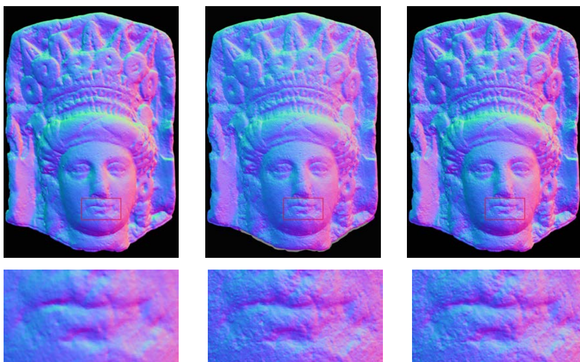
FIGURE 4.19 – Trois champs de normales issus des reconstructions 3D de la tête chypriote en représentation RVB. À gauche : photogrammétrie avec le logiciel Metashape. Au centre : stéréophotométrie calibrée avec dôme de RTI. À droite : méthode mixte géométrique/photométrique décrite par le diagramme de la figure C.2 (p. 145). La ligne du bas montre des agrandissements d’une zone située au niveau de la bouche.
