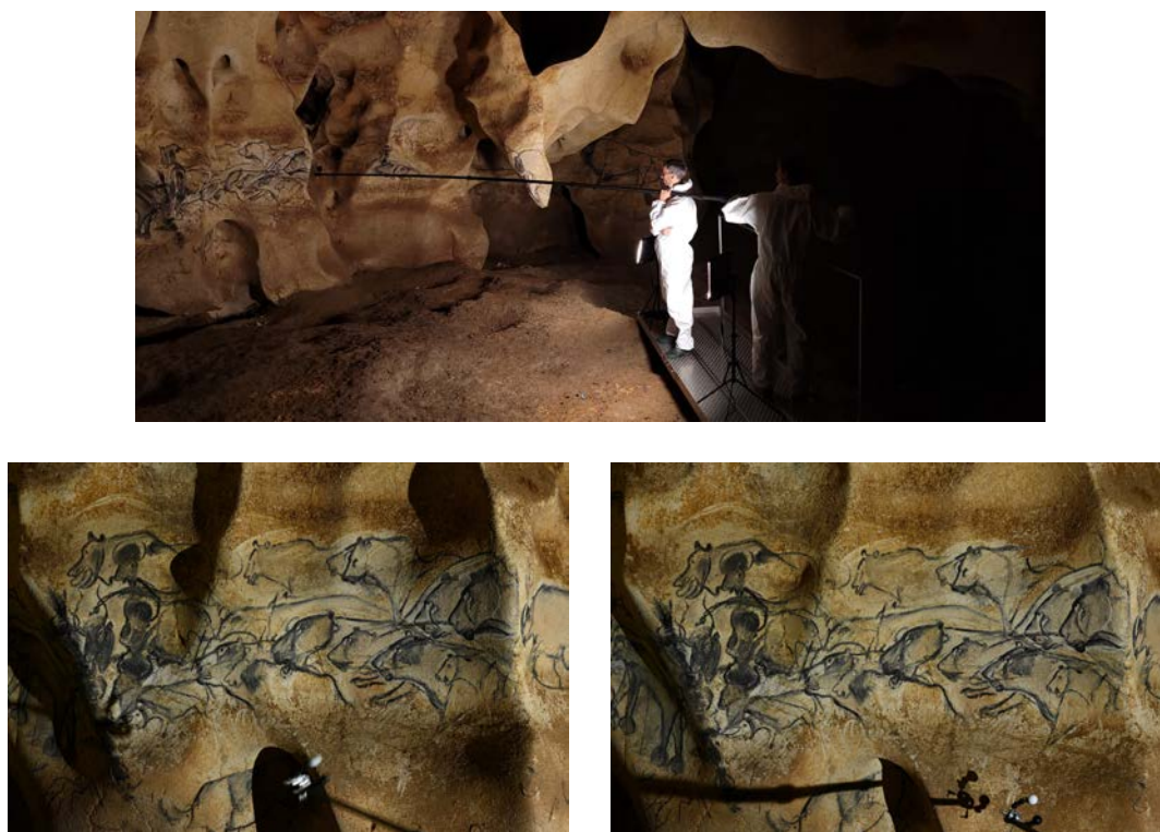
FIGURE 3.6 – Difficultés de mise en œuvre de la stéréophotométrie sur le panneau des Lions de la grotte Chauvet. En haut : la sphère d'étalonnage est positionnée près de la paroi à l'aide d'une perche. En bas à gauche : un temps de pose trop élevé, pourtant bien adapté aux conditions d'éclairage, rend l'image de la sphère floue, donc inexploitable. En bas à droite : l'image de la sphère devient nette après réduction du temps de pose et augmentation de l'ouverture de l'objectif, mais cela se fait au détriment de la profondeur de champ. Autre problème : la perche et la sphère projettent des ombres sur la paroi.
