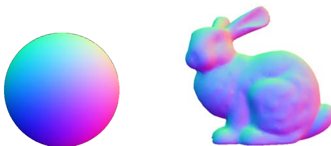
FIGURE 1.8 – Champs de normales en fausses couleurs RVB d'une sphère et du « lapin de Stanford ».
