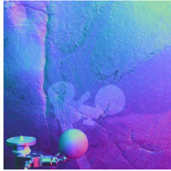
FIGURE 4.18 – Reconstruction 3D de la tête du cheval numéro 4 par stéréophotométrie calibrée, en utilisant une sphère d'étalonnage positionnée dans la scène (cf. photographie de droite de la figure 4.16, p. 135). En comparaison du résultat obtenu avec le dôme de RTI (cf. figure 4.17, p. 137), l'ombre de la sphère projetée sur le mur cause des artefacts nécessitant un traitement spécifique. De plus, le modèle d'éclairage directionnel provoque un biais d'estimation des normales dans les parties les plus éloignées de la sphère.
