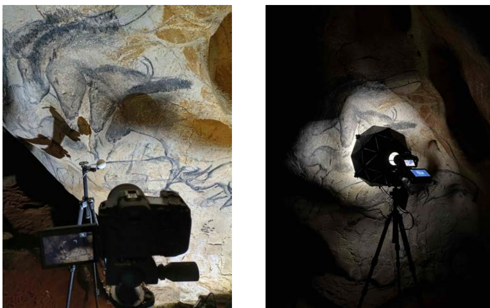
FIGURE 4.16 – Mise en œuvre de la numérisation par stéréophotométrie calibrée du panneau des Chevaux. À gauche : utilisation d'une sphère blanche (étalonnage a posteriori). À droite : utilisation d'un dôme de RTI (éclairage pré-étalonné).
