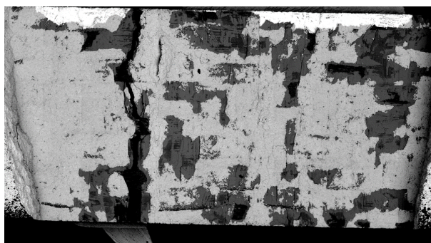
FIGURE 2.11 – Image MEB du faciès de rupture d'une éprouvette en mode BSE
