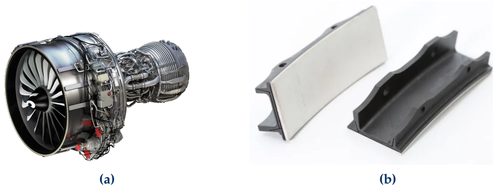
FIGURE 2 – (a) Moteur Leap-1A [Safran, 2017]. (b) Anneau de turbine réalisé en CMC SiC/SiC [3Dadep media, 2021]
