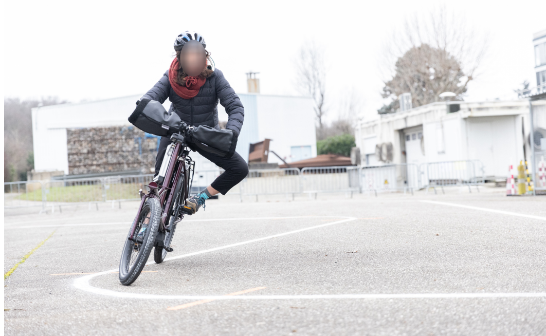
FIGURE 2.8 – Exemple d'un suivi de ligne lors du protocole UGE (Crédit : Sophie Jeannin). La tâche consistait à rouler à vitesse constante et à rouler au maximum sur la ligne blanche avec la roue avant, la performance de la tâche était mesurée à l'aide d'une caméra.
