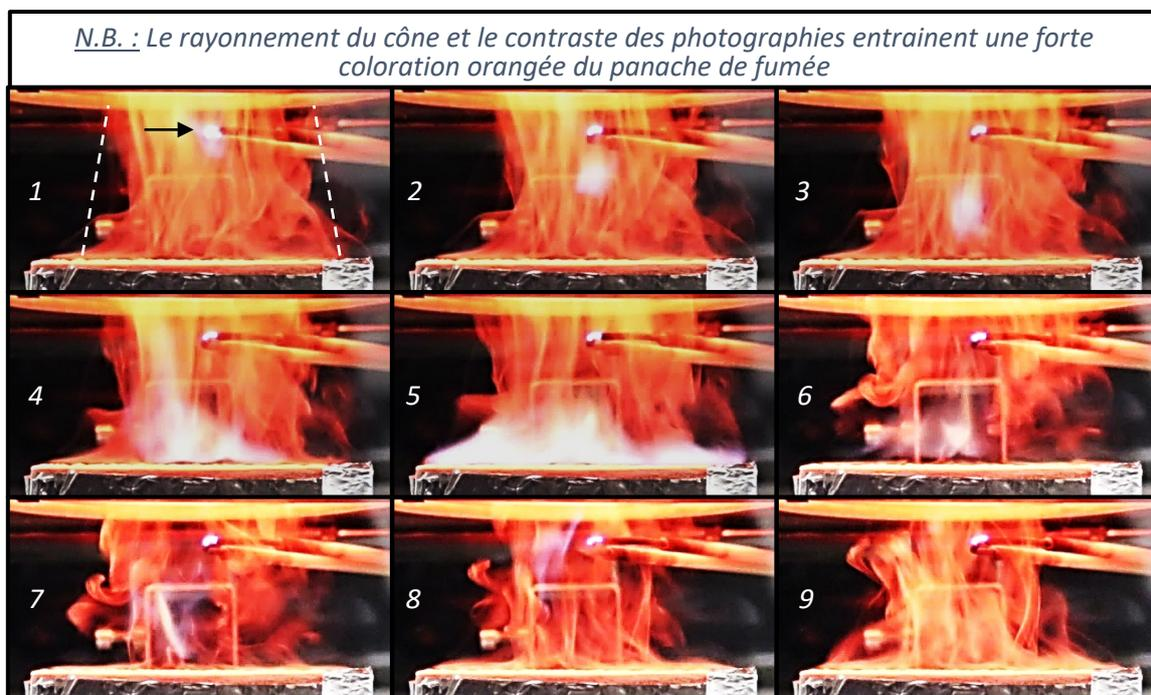
Figure 5.8 : Photographies du phénomène d'inflammation transitoire sur des échantillons de bois traité ;  $50 \text{ kW.m}^{-2}$  ; piloté
