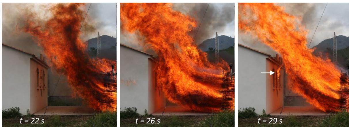
Figure 5.34 : Photographies d'un contact entre la flamme et la façade menant à une inflammation temporaire du volet (essai 3)
