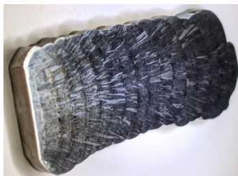
Figure II.7. Echantillon poli et attaqué avec le réactif de Kalling n°2.
