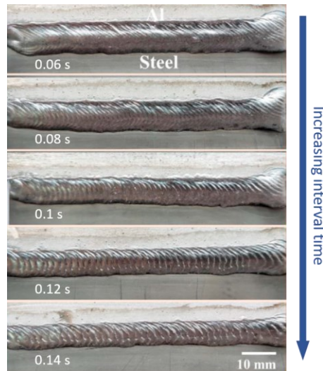
Figure 1.30. Apparence de cordons en CMT cycle step en faisant varier le temps de pause pour un nombre de cycles fixé à 4. Adapté de [151].
