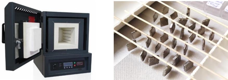
Figure 44 – Four à moufle MagmaTherm utilisé et échantillons de Ti-CP, suspendus sur une baguette d'alumine avec un fil de platine avant oxydation.
