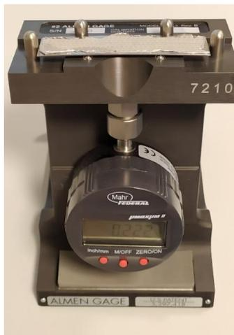
Figure 134 – Différentes étapes de la mesure de la flèche Almen dans le cas du traitement par choc laser.
