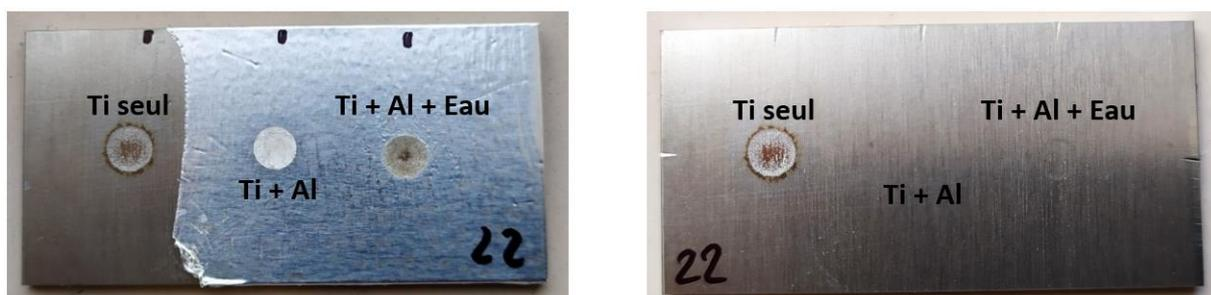
Figure 132 – Impact laser sur du titane nu (impact de gauche), sur du titane recouvert d’aluminium (impact du milieu) et sur du titane recouvert d’aluminium et d’eau (impact de droite). Photographies avant et après le retrait de l’adhésif d’aluminium.
