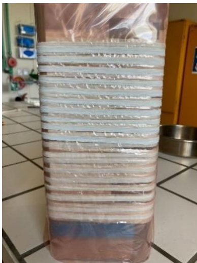
Figure 2-2 : Image d'une mèche imprégnée et enroulée sur mandrin carré de 12,5 cm de côté.
