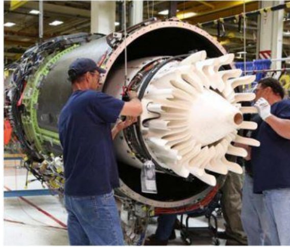
Figure 0-1 : Mélangeur en CMC oxyde/oxyde sur le moteur de General Electric Passport 20 [5].
