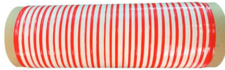
Figure 1-11 : Tow-preg Nextel™ sur un film de polyéthylène (en rouge) [35].
