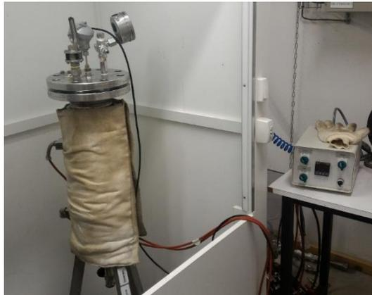
Figure 32 : Réacteur autoclave de 8L.
