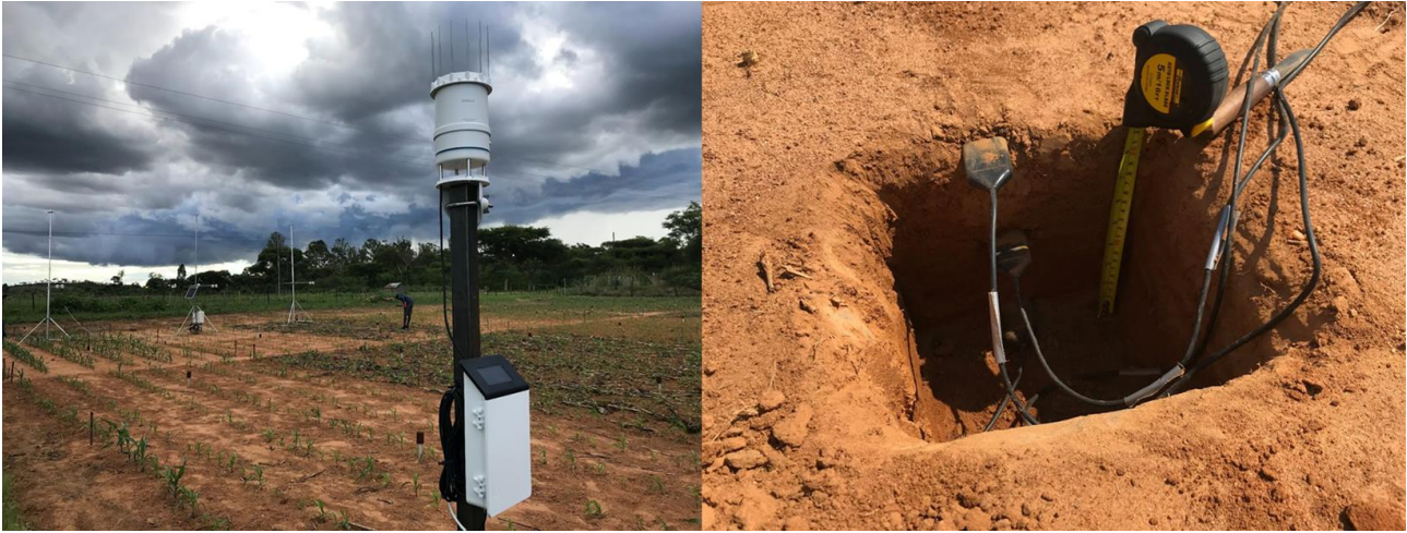
Figure 11. A gauche la station météo (METER group) pour mesurer la température de l'air, l'humidité de l'air, la vitesse du vent à 2 m de hauteur et la précipitation. A droite, les sondes pour mesurer en continu la température et l'humidité du sol à 1, 10 et 20 cm de profondeur.
