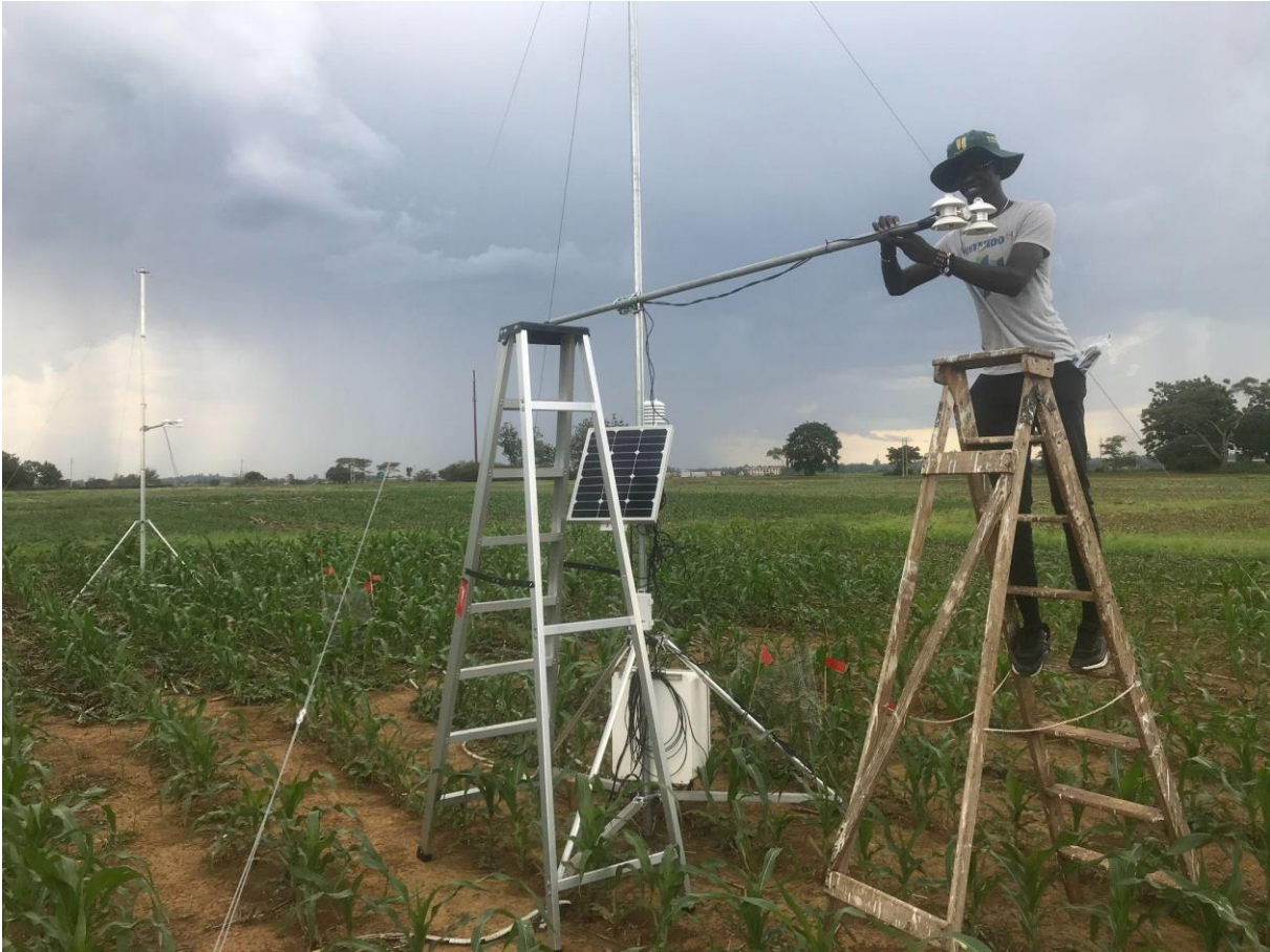
Figure A1 : Dispositif expérimental des radiomètres 4 composantes pour mesurer l'albédo et le rayonnement thermique (CREDIT : Rémi Cardinael ©)
