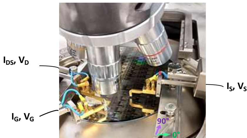
Figure 115 : Photo d'un wafer sur un banc de mesures de test sous pointes.
