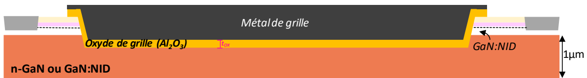
Figure 143 : Empilement et structure de type Van der Pauw.
