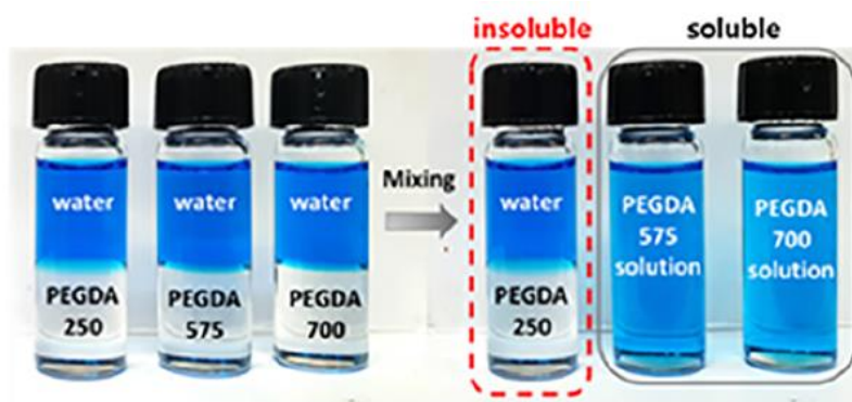
Figure 4.7 : Solubilité du PEGDA en fonction de la masse molaire (C. Nam et al. 2018)
