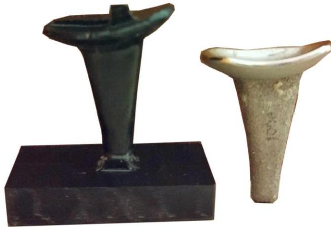
Figure IV-C-3-5: Tentative d'usinage d'un implant radial de prothèse de poignet (ReMotion)
