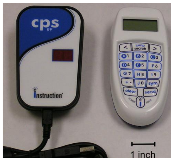
Figure 10. Boîtier de réception ARS (gauche) et boîtier de vote (droite) commercialisés en 2005 par einstruction.com.
