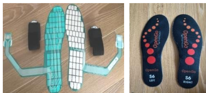
Figure 2.3. La semelle Fscan (Tekscan, USA) (image gauche), la semelle Moticon (ReGo AG, Munich) (image droite).
