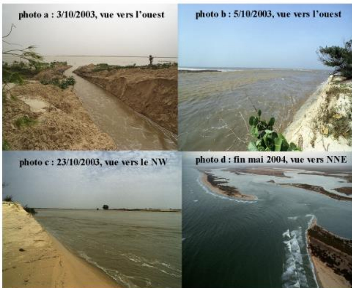
photo a : la brèche juste après son ouverture: 4 m de large photo b : la brèche 2 jours après son ouverture : 80 m de large photo c : la brèche 3 semaines après son ouverture : 330 m de large photo d, la brèche 8 mois après son ouverture : 800 m de large Source : photos Ibrahima Diop, service hydrographique de la ville de Saint-Louis
