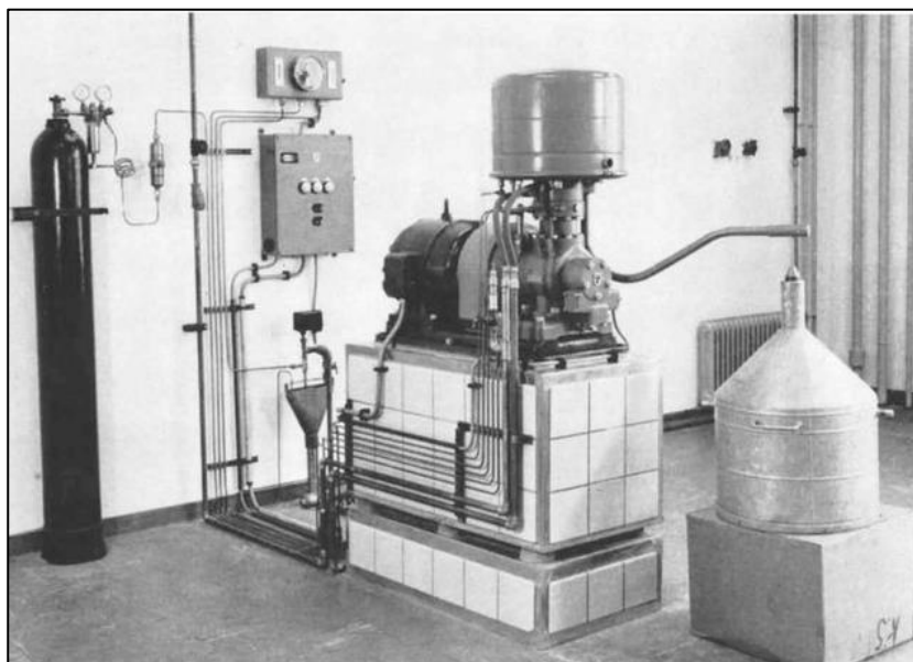
Figure 1-5 : vue de la première machine Stirling frigorifique Philips pour la liquéfaction de l'air [22].
