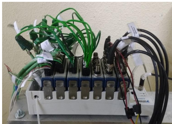
Figure 2-30 : système de mesure CompactDAQ NI 9172 du banc d'essais.
