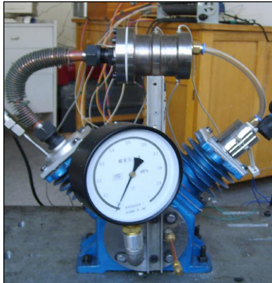
Figure 4-43 : machine Stirling frigorifique réalisée par Lean et al. [81].
