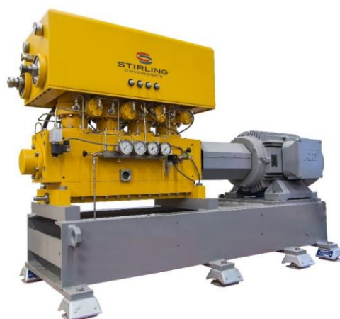
Figure 1-26 : cryogénérateur SPC-4 à quatre cylindres [40].
