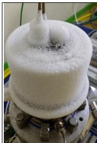
Figure 2-32 : vue de la tête froide de la machine Stirling à la fin d'un essai expérimental.
