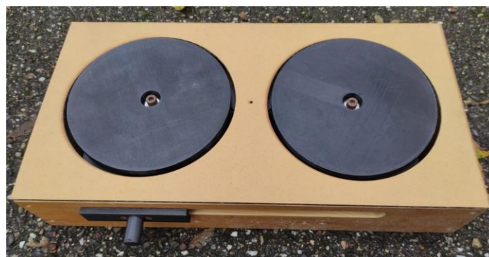
Figure 5.1 : Photographie du dispositif de plateau avec deux plateformes rotatives et poignée
