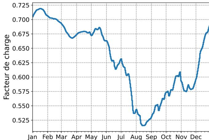
FIGURE 2.14 – Facteur de charge journalier simulé avec pyOTEC [96] d'une centrale ETM de 12 MW à La Réunion.
