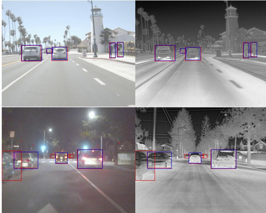
FIGURE 5.9 – Paires visible-infrarouge issue de la base FLIR-aligned. La vérité-terrain est encadrée en rouge, tandis que les détections réalisées par CAFF-DINO sont en bleu. Le seuil de confiance a été fixé à 50 %.
