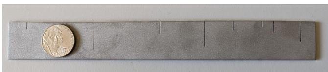
FIGURE 4.15 – Prise de vue de l'échantillon métallique indenté. La plupart des indentations sont visibles à l'oeil nu ainsi que la rugosité ajoutée par le sablage.
