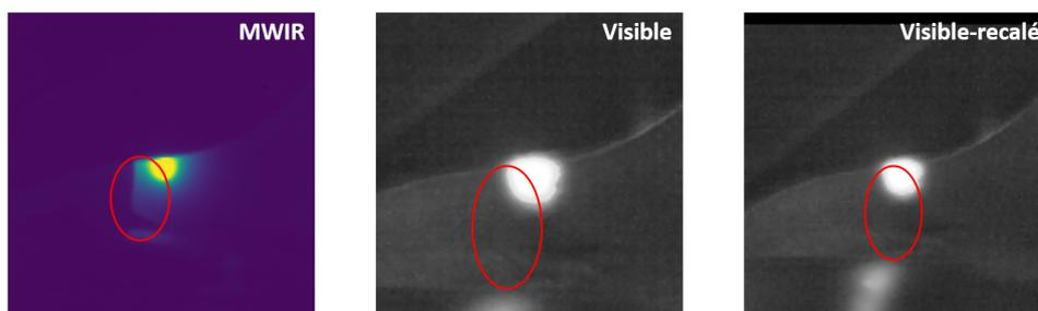
FIGURE 6.6 – Exemple d'acquisition avec fissure : image thermique individuelle - visible imparfaitement recalé (centrage+découpe) et visible recalé. Le défaut entouré en rouge est ici à peine perceptible en spectre visible.
