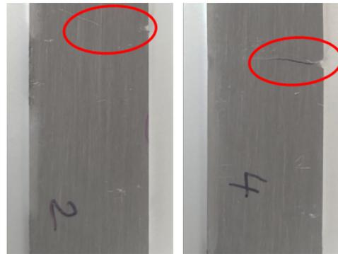
FIGURE 1.11 – Vue rapprochée des échantillons 2 et 4. Ces deux exemples illustrent la diversité des faciès de fissuration.
