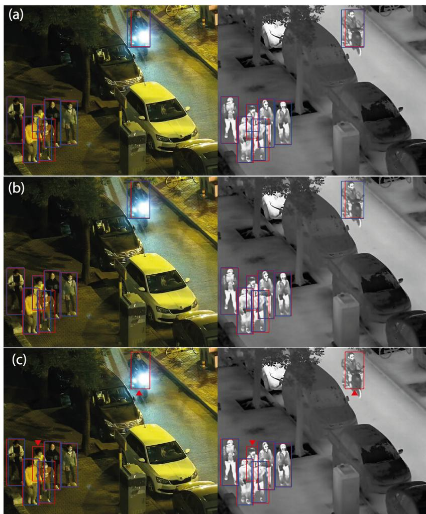
FIGURE 5.12 – Paires d’images visibles et infrarouges issues du jeu de test LLVIP. (a) est la détection de CAFF, (b) est la concaténation et (c) est la similarité cosinus. La vérité terrain est encadrée en rouge tandis que la détection de notre modèle est encadrée en bleu. Le seuil de confiance est de 50 %. Un triangle rouge indique la détection manquée.
